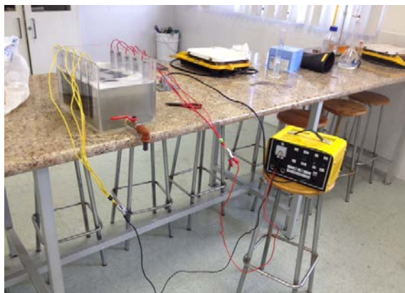
Figura 16: Conexiones eléctricas del electrocoagulador y fuente de energía
