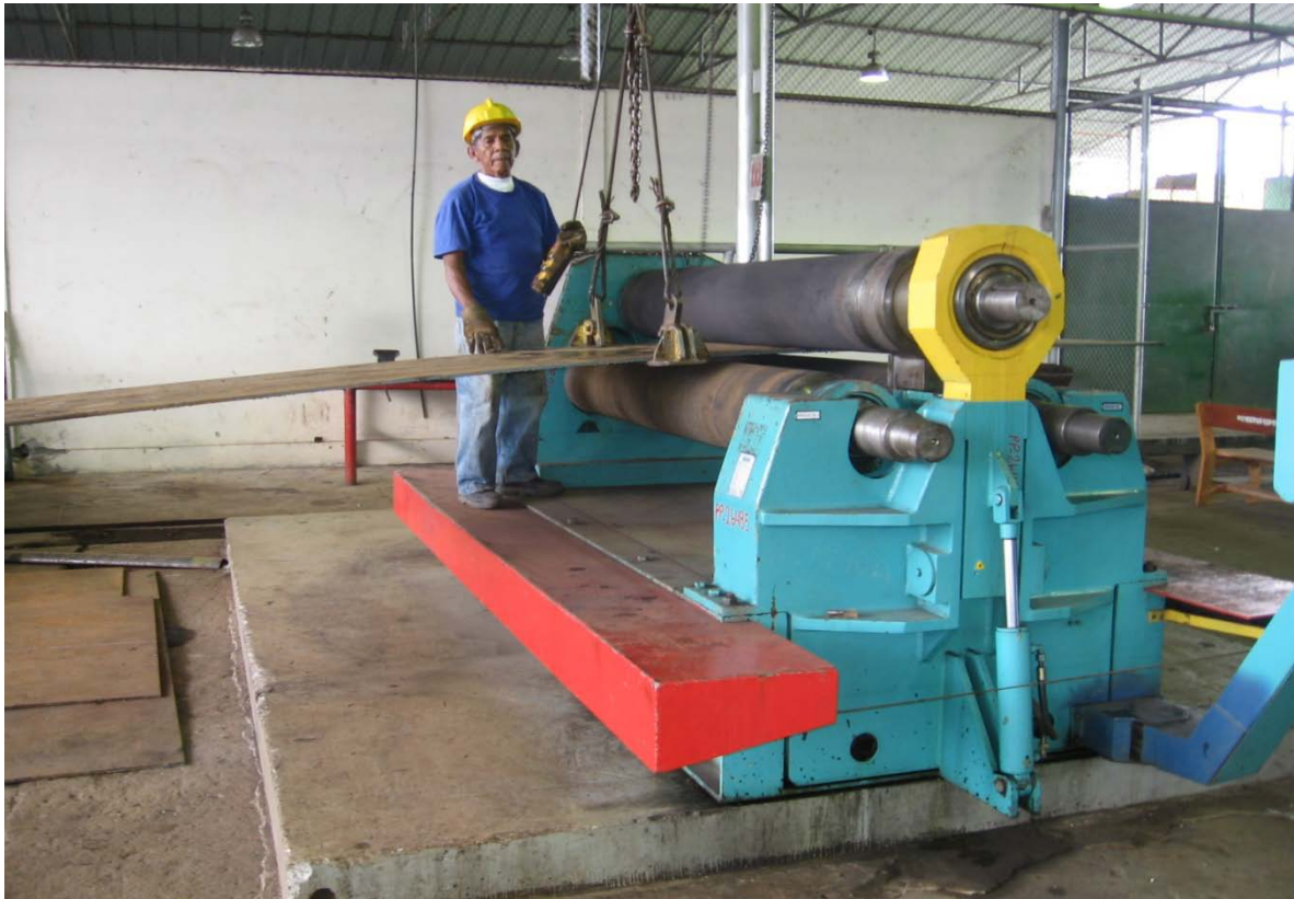
Proceso de barolado de láminas para construcción de tanques u otro elemento de facilidades de superficie
