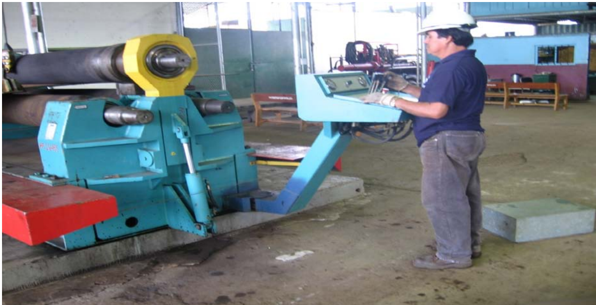
Operación y Control de la baroladora para el doblado de las láminas
