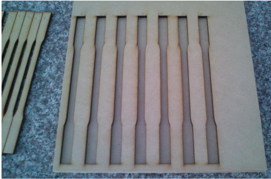
Figura 2. Molde Fabricado en MDF para Probetas de Ensayo a Tracción
