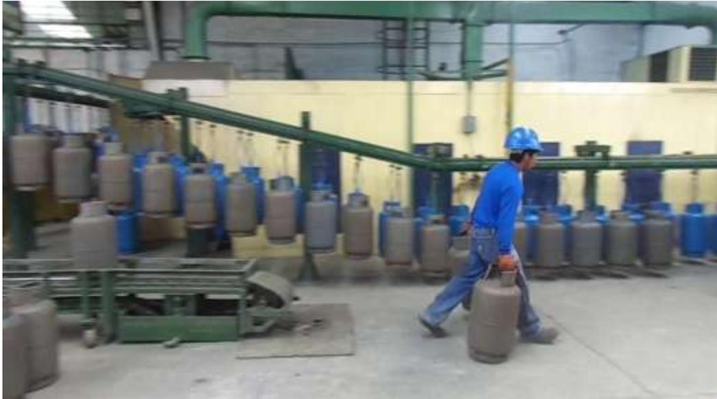
**Gráfico 35. Colocación de cilindro en cadena transportadora**
