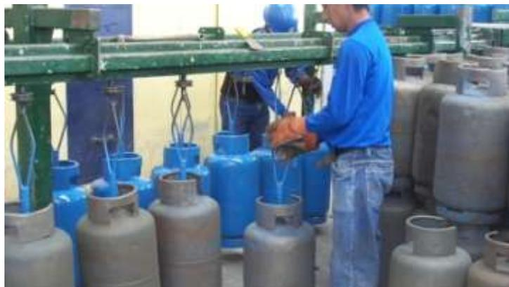
**Gráfico 36. Desmontar cilindro de la cadena**
