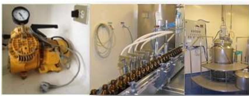
Grafico N° 32: Máquinas para trabajar en la fuente: bomba de microbiología, banda transportadora, reactor homogenizador de pastas dentales
