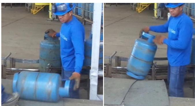
Una vez en la banda transportadora el cilindro pasa a la digitación de la tara, en donde adicionalmente se separa los cilindros de otras marcas y aquellos que poseen alguna deficiencia. Esta clasificación se realiza mediante inspección visual, seleccionando los cilindros deficientes debido a defectos como corrosión, dobles de asas o base, inflados, golpes punzantes, pliegues y/o abolladuras para posteriormente ser trasladados al taller de mantenimiento.
