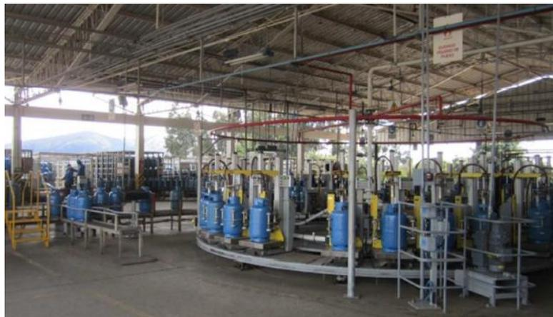
Posterior a esta se realiza la determinación de fugas en los cilindros mediante un sistema automático de absorción de aire circundante al cilindro, en especial en la unión de la válvula, filtrándose el aire por un contador de partículas por medio de rayos infrarrojos, siendo comparado con un parámetro permisible previamente determinado en el equipo.
