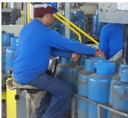
El llenado de los cilindros de 15 kg. en el envasado de GLP propiamente dicho y se lo realiza en 2 carruseles de 24 balanzas electrónicas, teniéndose un sistema de ingreso – salida y posicionamiento automático para los cilindros. Es así que, cada cilindro es asignado a una balanza, la misma que recibe en forma electrónica la tara digital y a partir de los se inicia el llenado del GLP en el
