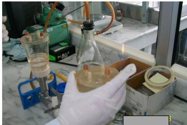
7.- Se abre la válvula del embudo de filtración y se espera que toda el agua se filtre por el embudo hacia los vasos de precipitado finales donde se encontrarán las moléculas de diámetro menores a los coliformes.
