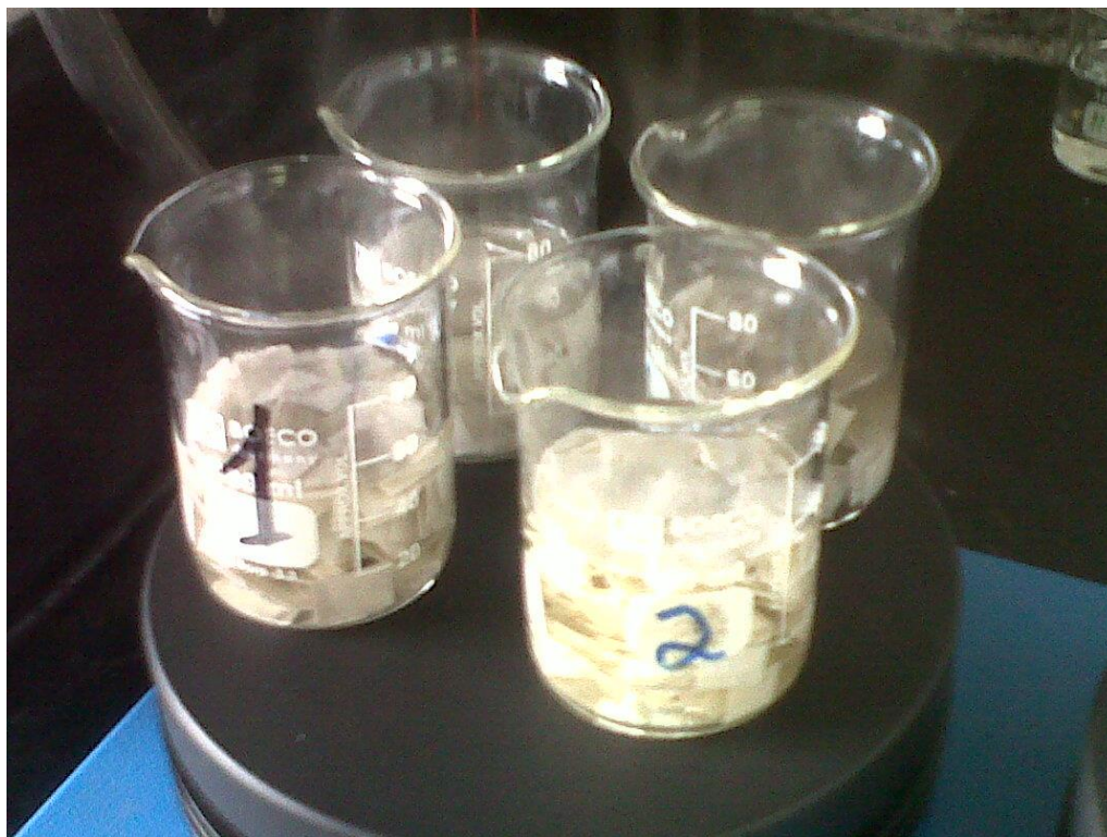
Foto #7. Calentamiento de la mezcla ácida (140°C).
