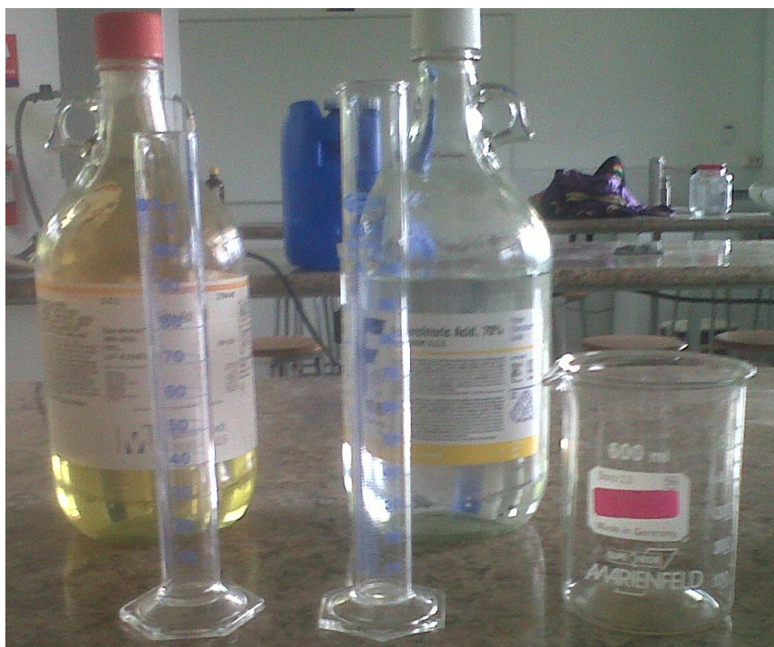
Foto #6. Preparación de la mezcla ácida (Ácido nítrico y perclórico).
