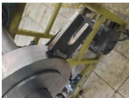
*Figura 32.* Suelda de la placa guía al freno, por Carlos Moscoso (2013).
