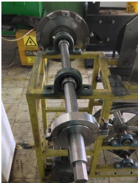
*Figura36.* Eje con todos sus elementos ensamblado, por Carlos Moscoso (2013).
