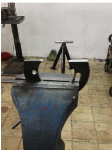
*Figura 23.* Corte en placa de soporte del motor de arranque, por Carlos Moscoso (2013).
