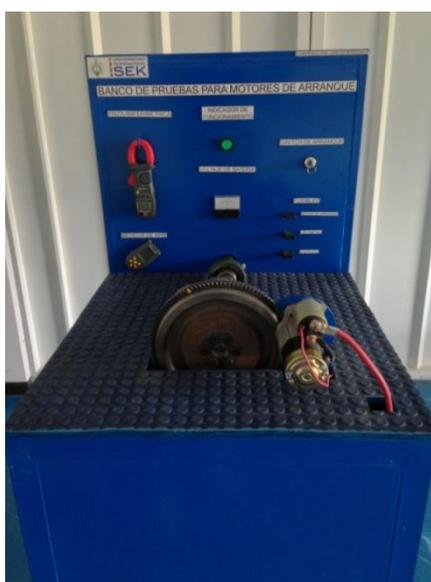
*Figura37.* Banco de pruebas para motores de arranque terminado, por Carlos Moscoso (2013).
