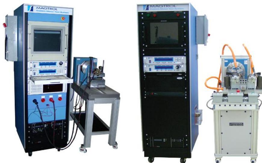
*Figura 1.* Bancos de prueba para motores de arranque Magtrol, recuperado de <http://www.magtrol.com/datasheets/cmts-starter2.pdf>
