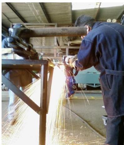
*Figura 30.* Suelda de bisagra al freno, por Carlos Moscoso (2013).
