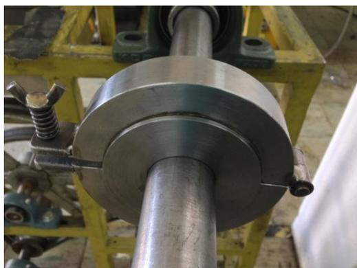
*Figura 29.* Freno terminado y colocado sobre el eje de soporte, por Carlos Moscoso (2013).
