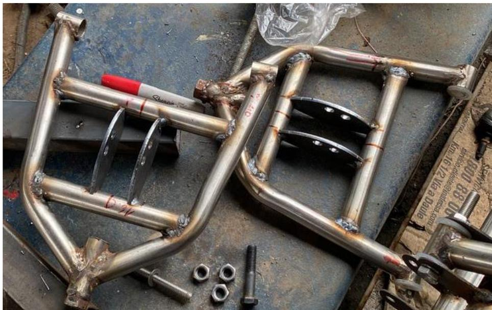
*Nota.* Verificar que las medidas de las horquillas sean la mismas para facilitar el proceso de soldadura.
