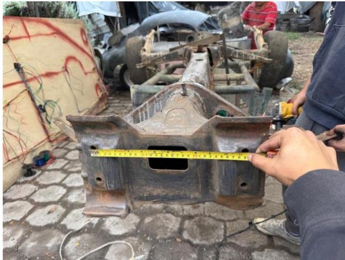
*Nota.* Mediciones iniciales de las bancadas para la adaptación de la suspensión de doble horquilla.
