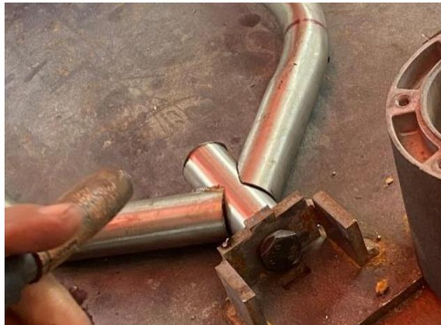
*Nota.* Se realizó unos puntos de suelda, para verificar la posición de las horquillas.
