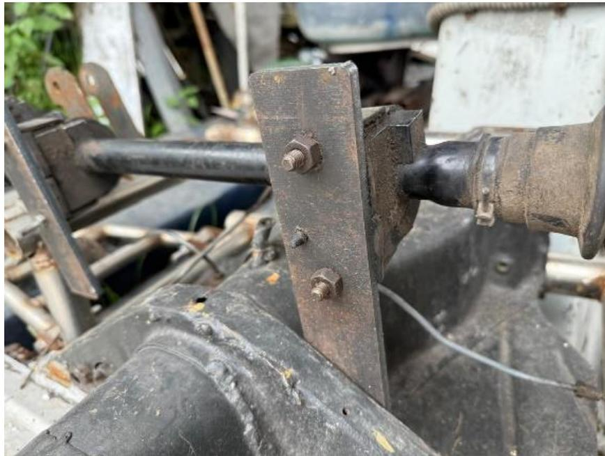
*Nota.* Se usó un espesor de 5 mm para los soportes para asegurar un buen soporte.
