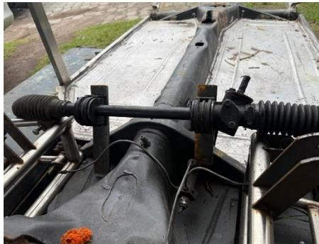
*Nota.* Cremallera mecánica por facilidad de colocación por su falta de componentes.
