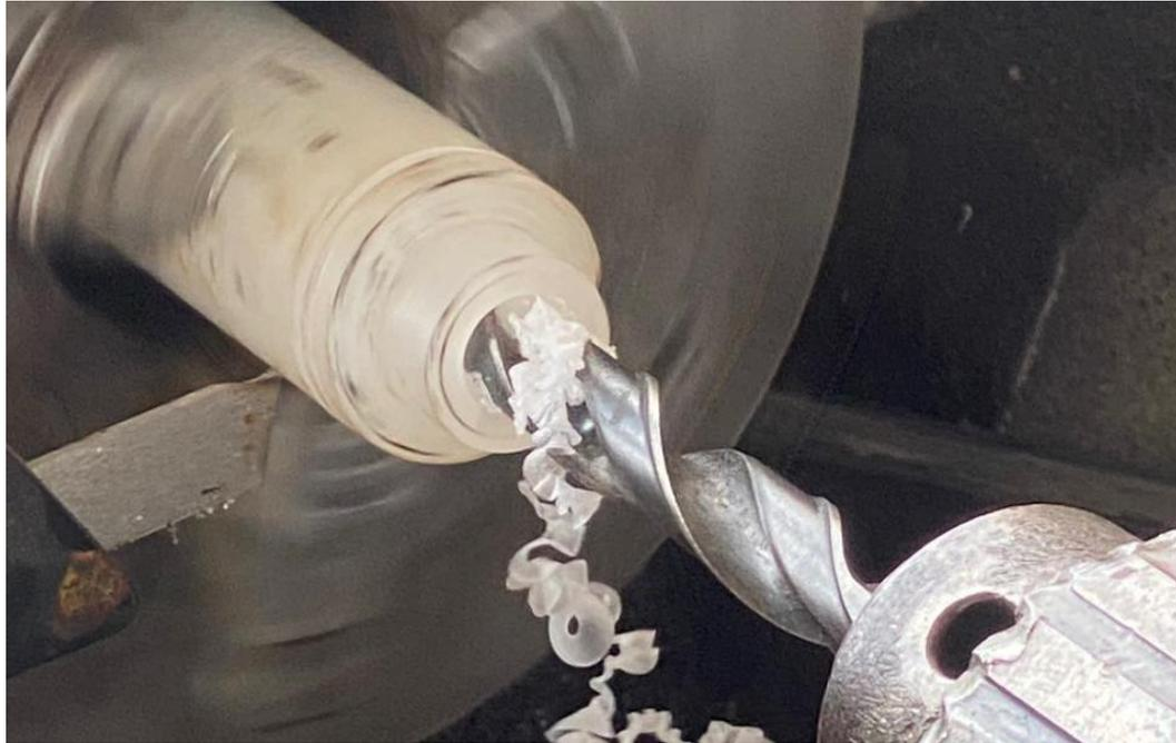
*Nota.* Torneado de los bujes en el diámetro interior del tubo
