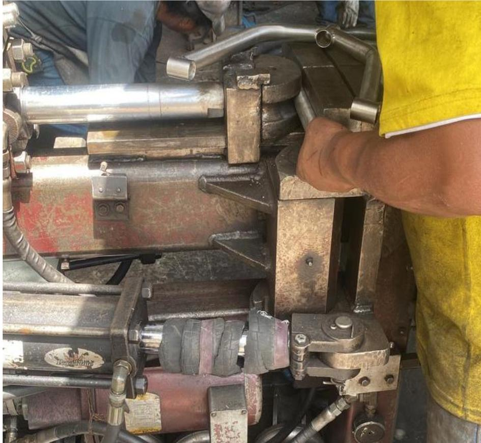
*Nota.* Para el doblado de tubos fue necesario de una prensa hidráulica
