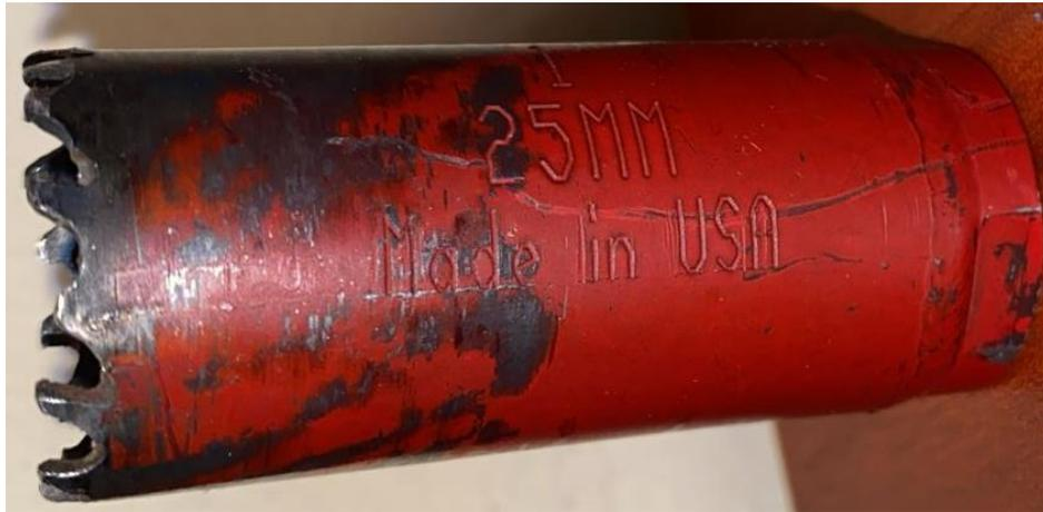
*Nota.* Broca de la marca MORSE, empleada para la perforación de la forma boca de pescado, para los tubos.
