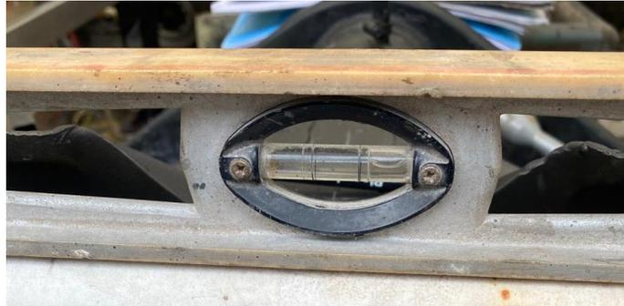
*Nota.* Es necesario tener a nivel el chasis, para no desfasar las medidas de los soportes de las horquillas.
