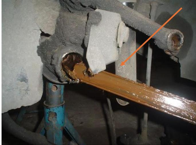
*Nota.* Foto referencial de la barra de torsión en mal estado normalmente por falta de mantenimiento. Tomado de Barras suspensión quebradas Kombi VW. (s. f.).
