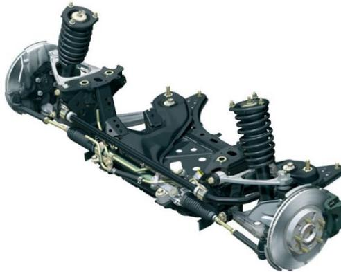
*Nota.* Suspensión de doble horquilla, tomado de Menmolira, Suspensión independiente. (Repuestos De Suspensión Y Frenos Renault – Tecnicentro Antioquia, n.d.)
