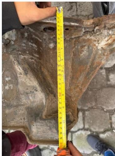
*Nota.* Medición de profundidad para el acople de las bases de las horquillas.
