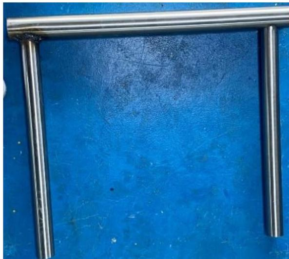
*Nota.* Presentación de tubos de 1 ½ a 2 pulgada para el ensamble de las bases de la suspensión. El proceso se realizó 2 veces para el ensamble de las bases de la suspensión en las cuales irán apoyadas en el chasis del Volkswagen Beetle.
