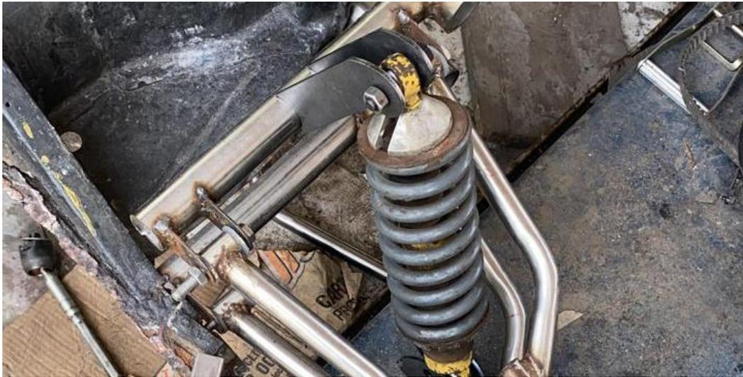
*Nota.* Se da uso del amortiguador para verificar las dimensiones de las piezas.
