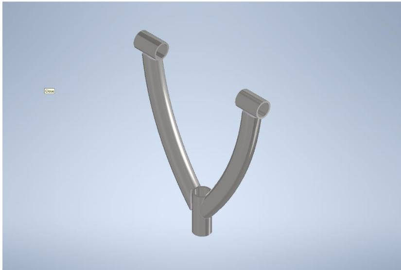
*Nota.* Diseño de la horquilla en el programa de diseño, de Auto CAD (inventor), este diseño es para las cuatro horquillas de la suspensión.
