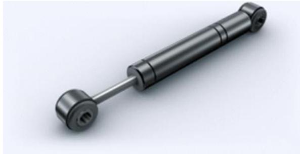
*Nota.* amortiguador encargado de absorber vibraciones. Obtenido de: Amortiguador: Funciones y características | Blog buscador de talleres. (s. f.).
