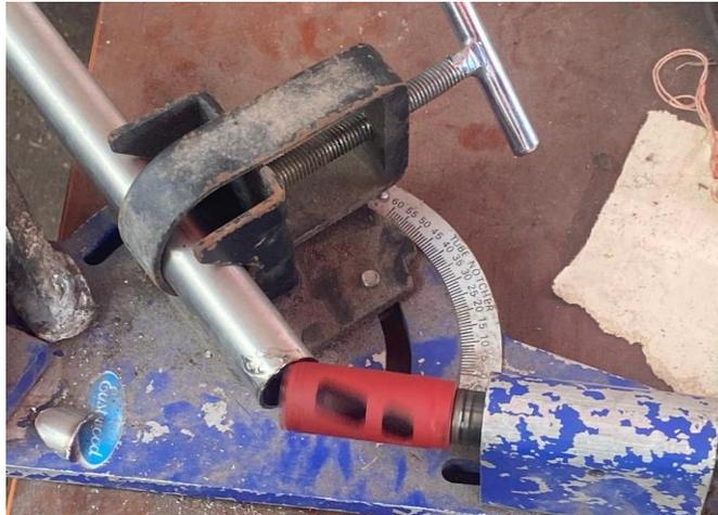
*Nota.* La perforación se hizo con el tubo a un ángulo de 45 grados. Con una presa para tubos, específica para tubos.
