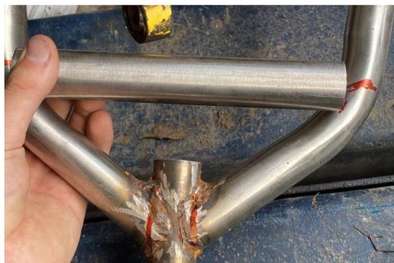
*Nota.* Se recomienda tomar en cuenta la forma de la horquilla para facilitar el corte del tubo y que garantice una buena superficie de contacto para la soldadura.
