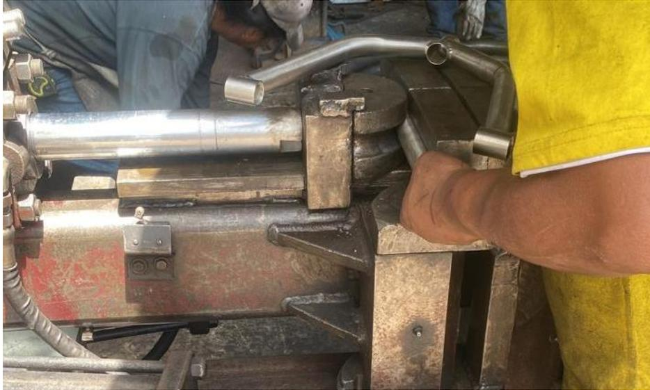
*Nota.* Fue necesario la implementación de una dobladora hidráulica para el doble de los tubos, debido a la precisión que esta presenta.
