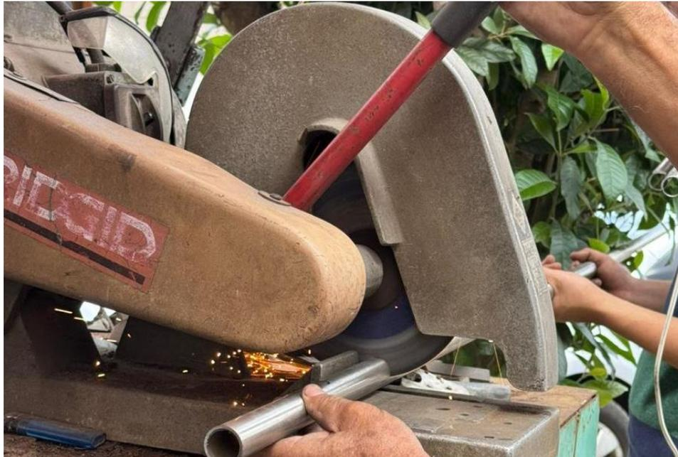
*Nota.* Cortado los tubos en ingletadora en las marcas previamente señalizadas
