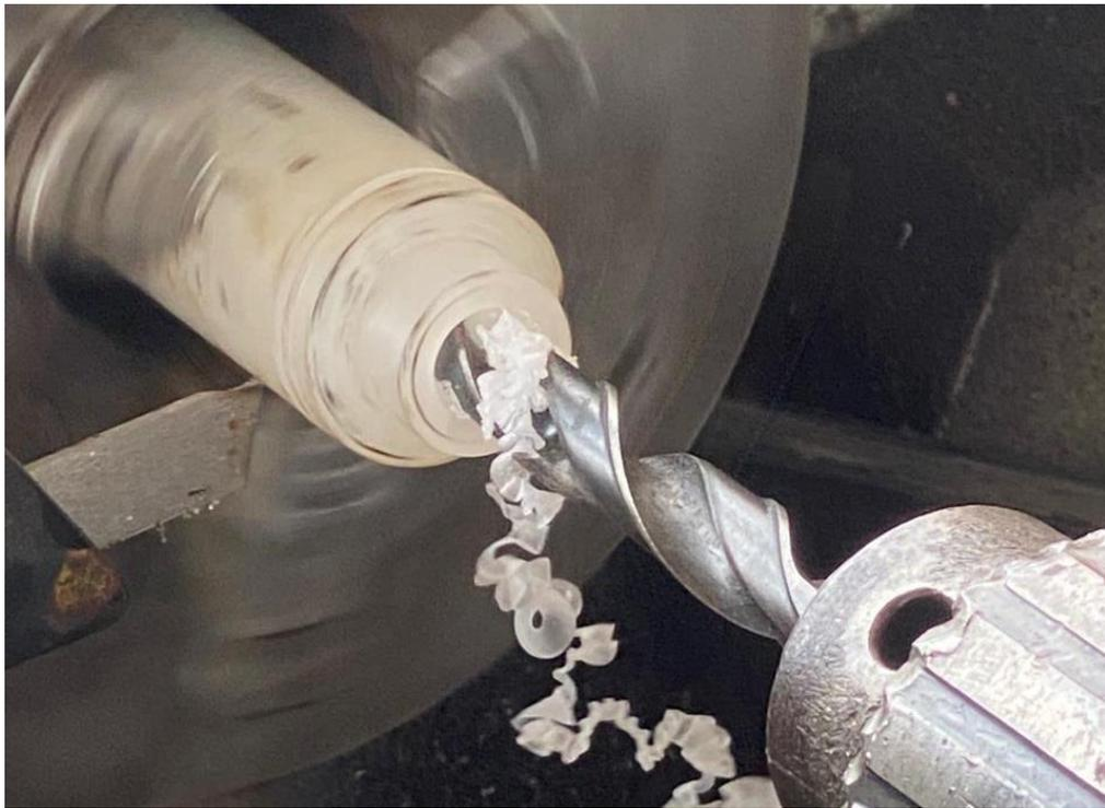
*Nota.* El torneado permite crear piezas simétricas, de manera eficaz y uniforme por el tipo de funcionamiento que dispone. Lo cual nos permitió realizar los bujes que irán en las bases de las horquillas.
