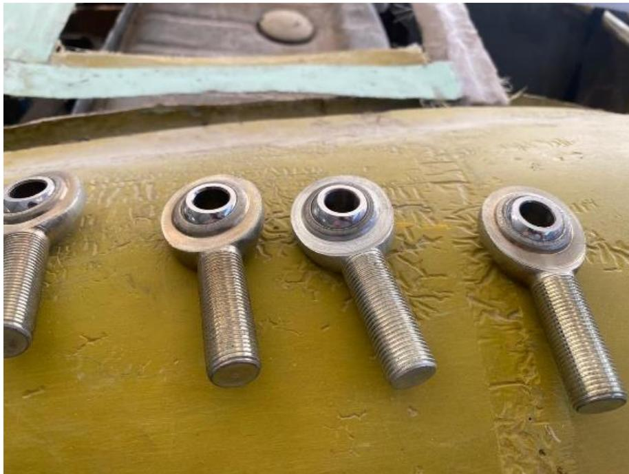
*Nota.* Se implementó la importación de las uniballs, para la adaptación de las horquillas, con las manzanas.
