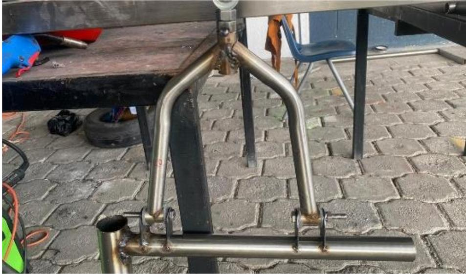
*Nota.* Soldado de los soportes de las horquillas en los tubos de dos pulgadas para el subchasis
