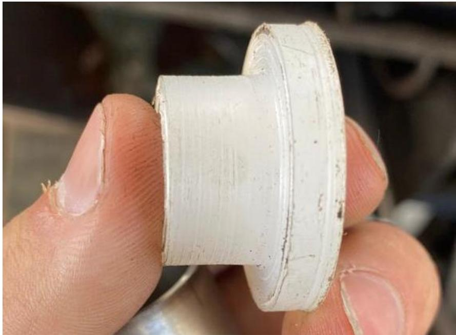
*Nota.* Está torneado con el diámetro interior del tubo en el cual se va a apoyar, para evitar vibraciones, Son dos por tubo, lo cual el total es de 24 bujes para la suspensión.
