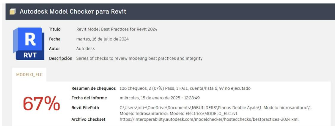
Figura 4.21 Primer resultado de la auditoria modelo eléctrico (BIM B01)
