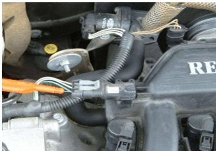
*Nota.* Instalación efectuada de Sensor MAP.
