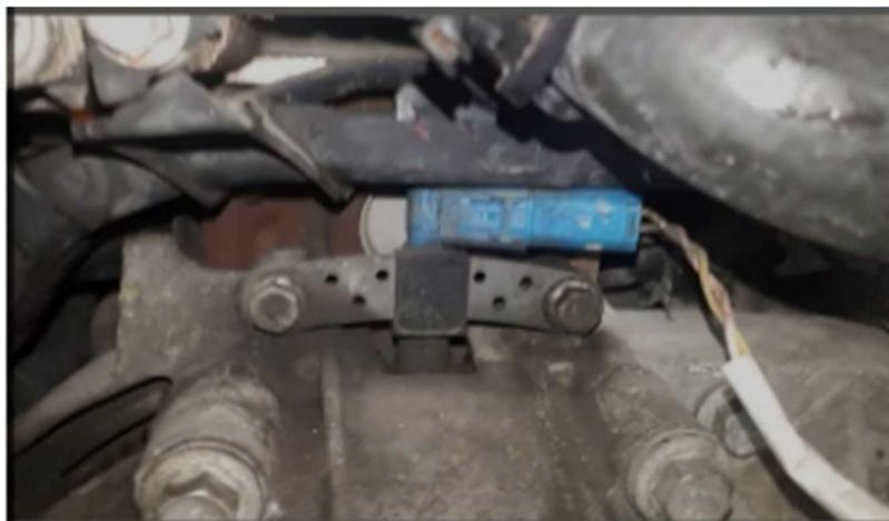
*Nota.* Instalación efectuada de Sensor CKP.
