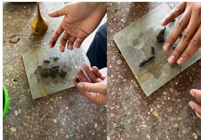
Figura 47. Prueba Plasticidad Suelo
