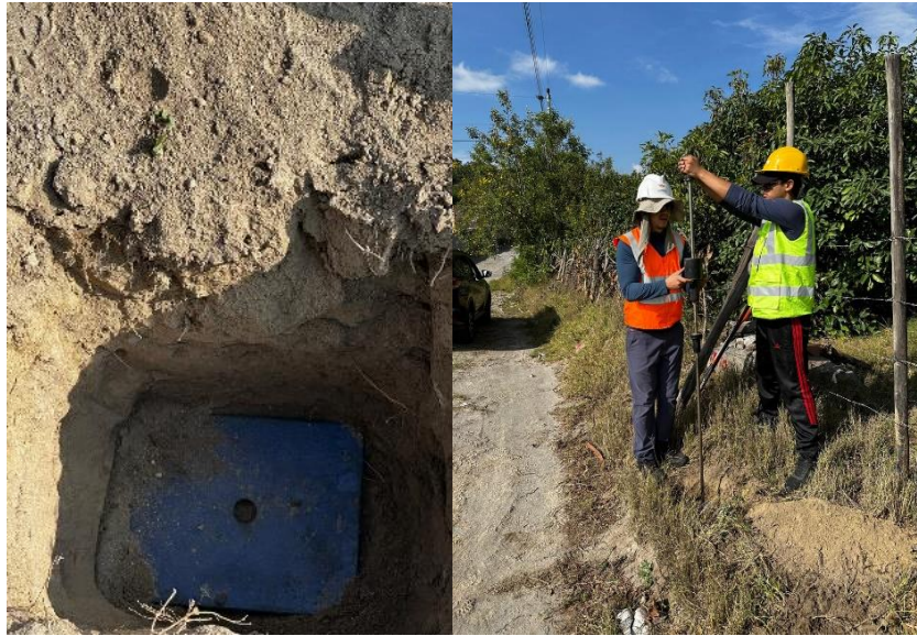
Figura 40. Ensayo cono Dinámico en campo
