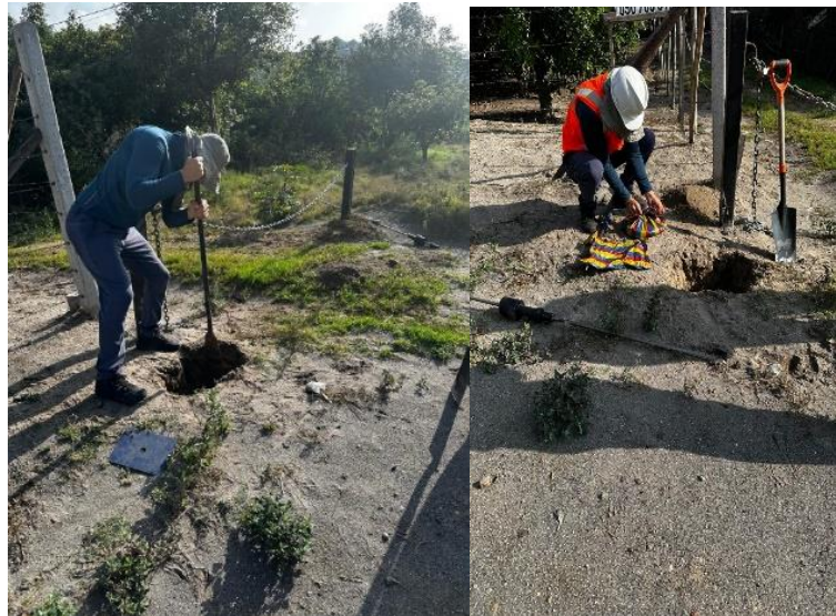
Figura 39. Obtención de muestra de suelo in situ
