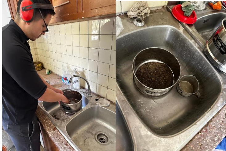
Figura 43. Lavado muestras de suelo a través del tamiz #200
