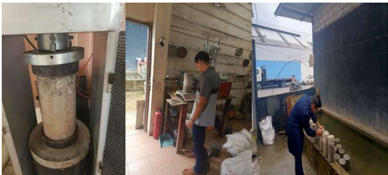
Ilustración 15: Recolección de datos en el ensayo de compresión de cilindros f'_c de 210 kg/cm 2 .
