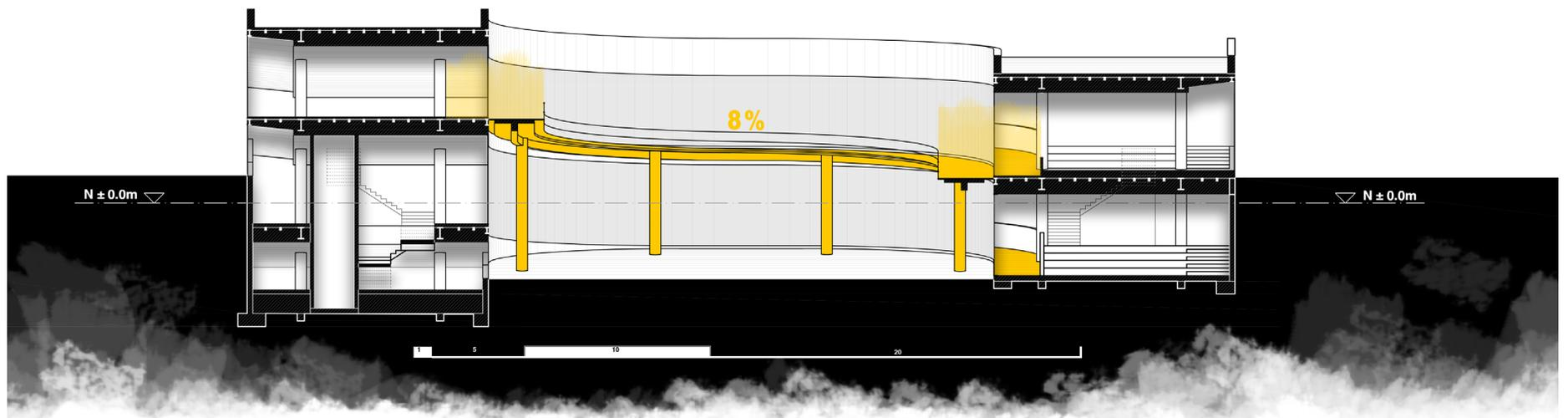
Fig 156. Corte y Perspectiva de la rampa pública
