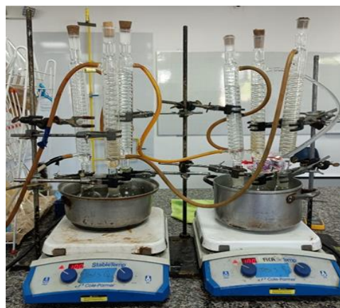
Figura 7. Equipo de reflujo para saponificación de biomasa de Chlorella vulgaris (se utilizó para calcular el porcentaje de AGL) (Guatemala, 2023).
