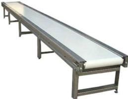
A long, narrow conveyor belt with a metal frame and a white belt surface.                                               | Máquina de 100 cm x 30 cm de acero inoxidable AISI 304, su función es transportar los materiales desde la etapa de lavado hacia la extracción de la pulpa. |
