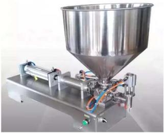
A stainless steel bottle filler with a large cylindrical tank on top and a dispensing mechanism with a nozzle at the bottom. | Máquina de 25 lt de capacidad, se ocupa para envasar el licor terminado en las botellas. Trabaja con altos estándares de higiene.  |
