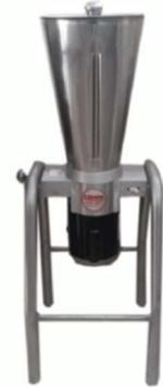
A stainless steel industrial blender with a large conical hopper on top and a motor base on a four-legged stand.            | Máquina de capacidad de 20 lt cuya funcionalidad es homogeneizar las materias primas previo a la etapa de trasiego y fermentación. |
