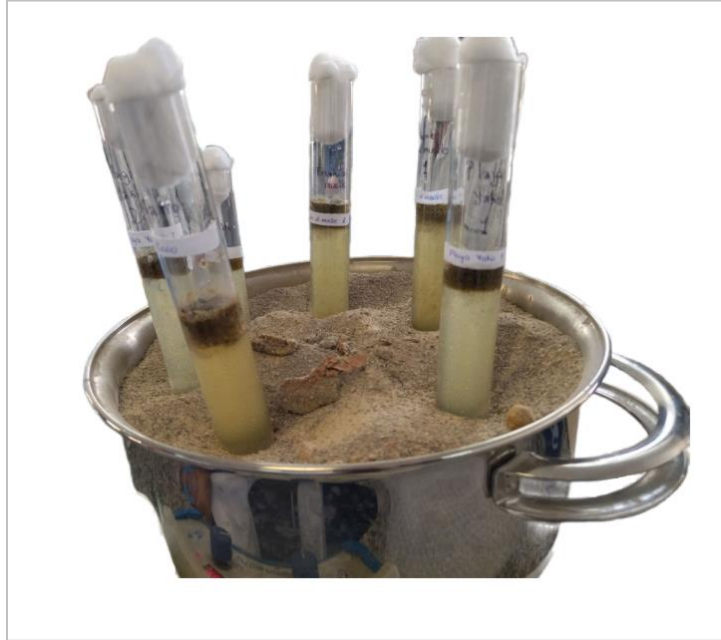
Figura 2: Proceso de digestión y sedimentación de muestras de Limoncocha.
