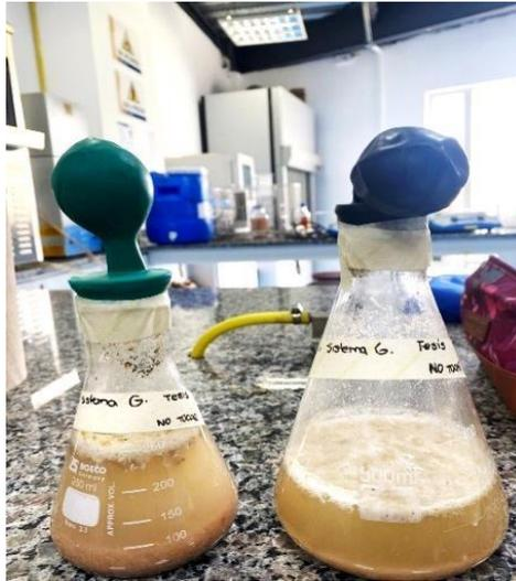
*Ilustración 3: Fase anaerobia, generación de CO<sub>2</sub>, técnica de intercambio de gases*
