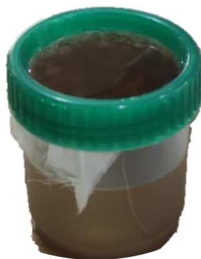
Figura 4. Muestra filtrada con malla 13 XXX-100. Elaborado por: (Estrada, 2024).
