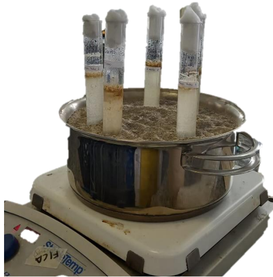
Figura 5. Limpieza de muestras con peróxido de hidrógeno y ácido clorhídrico. Elaborado por: (Estrada, 2024).
