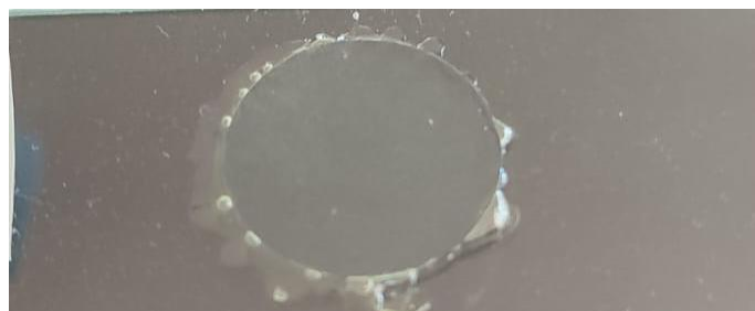
Figura 6. Fijación de muestras con Naphrax ® . Elaborado por: (Estrada, 2024).
