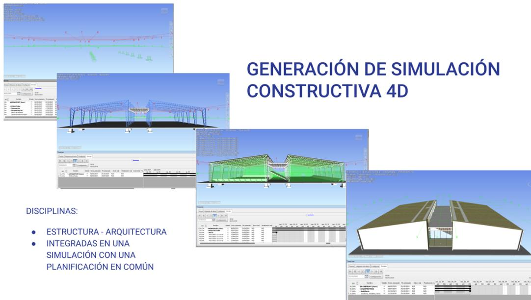
*Ilustración 22, proceso para generar simulación constructiva Navisworks, fuente master BIM*
