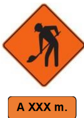
Figura 11. Señal “Trabajo en la vía con distancia”
