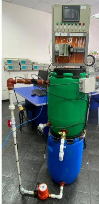
En cuanto a programación de PLC's este modulo les permite a los estudiantes relacionarse con sensores, como el sensor de caudal, sensor de nivel y el transmisor de temperatura, además de actuadores como la bomba de agua y la electroválvula solenoide.
