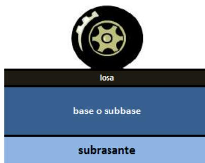
*Ilustración 11. Esquema de paquete estructural del pavimento rígido*
