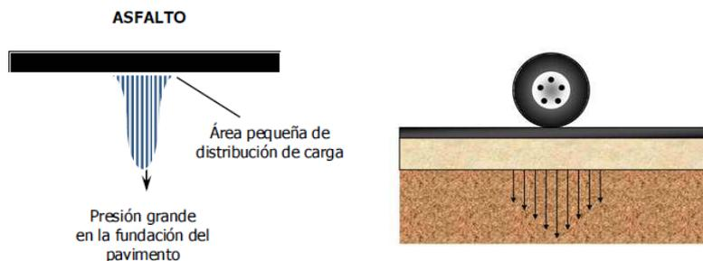
*Ilustración 10. Esquema de comportamiento del pavimento flexible*
