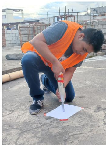
*Ilustración 25 Ensayo del esclerómetro*
