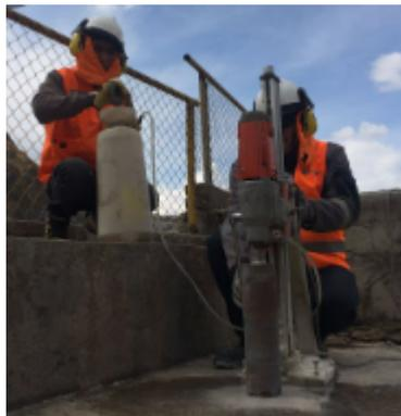
*Ilustración 16 Ensayo de diamantina*
