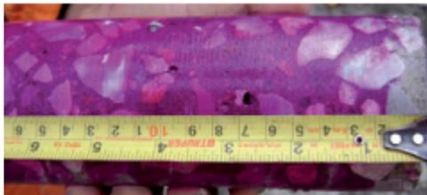
*Ilustración 17 Ensayo de carbonatación*
