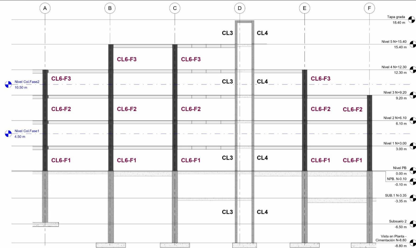
4 Pórtico de Columnas Metálicas / eje 4
