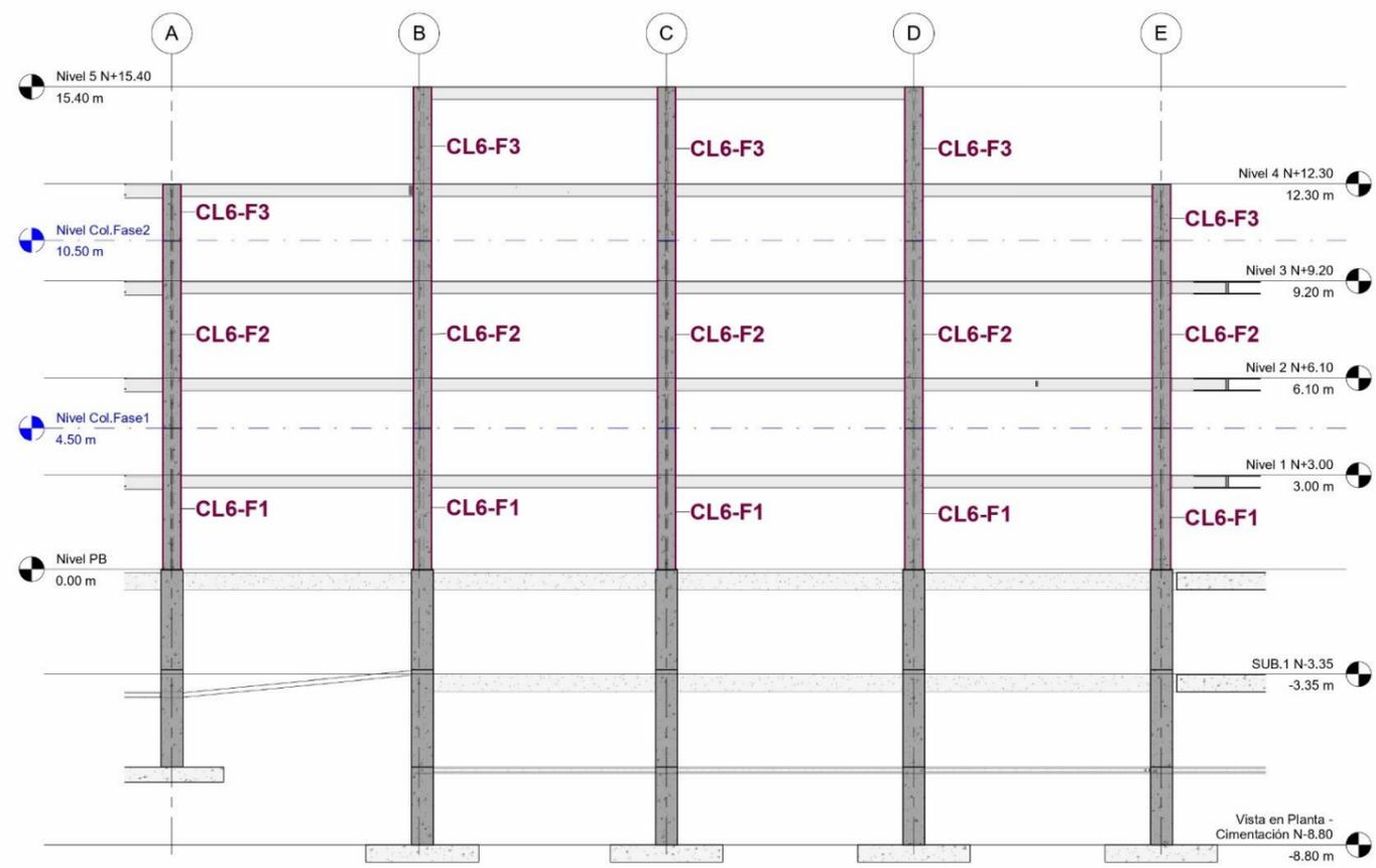
2 Pórtico de Columnas Metálicas / eje 2
