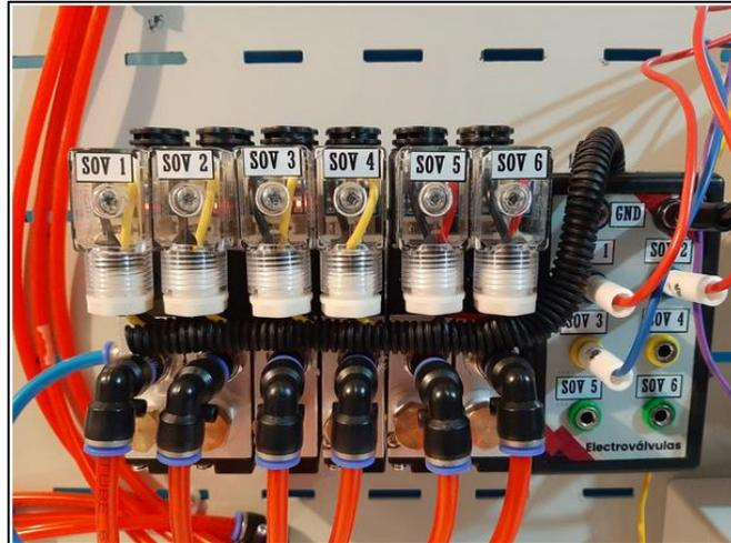
**Circuitos neumáticos*****Circuito de accionamiento neumático indirecto de un cilindro giratorio de 90 grados***
