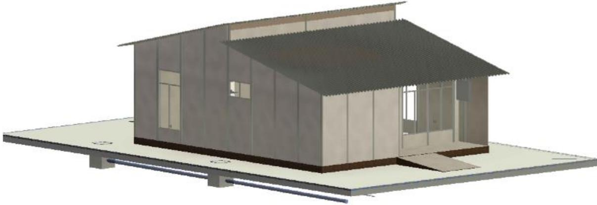
*Figura 20. Paneles de fibrocemento.*
