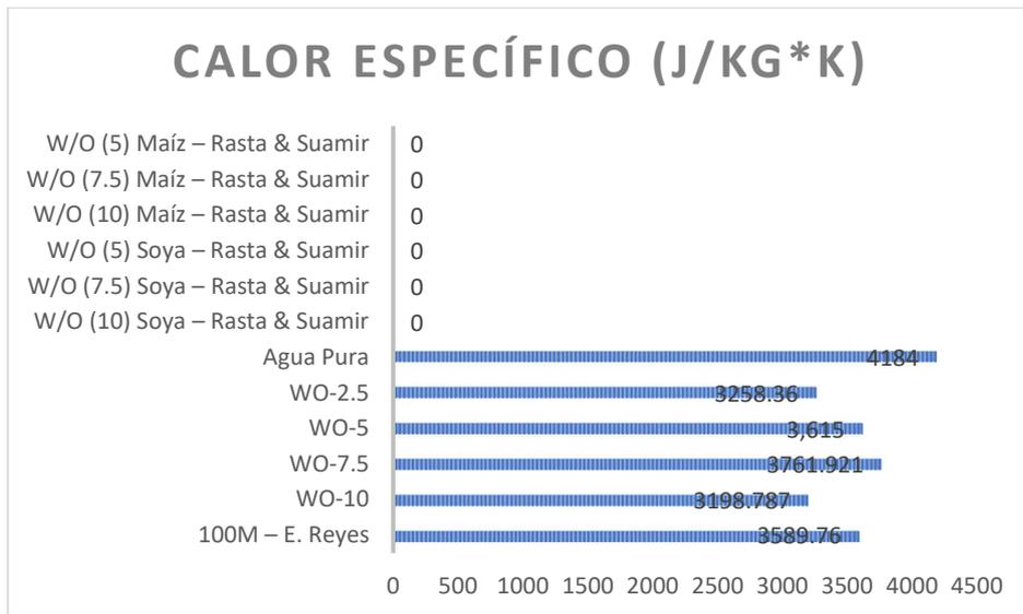
Figura 52: Calor Específico en Diversos materiales PCM
