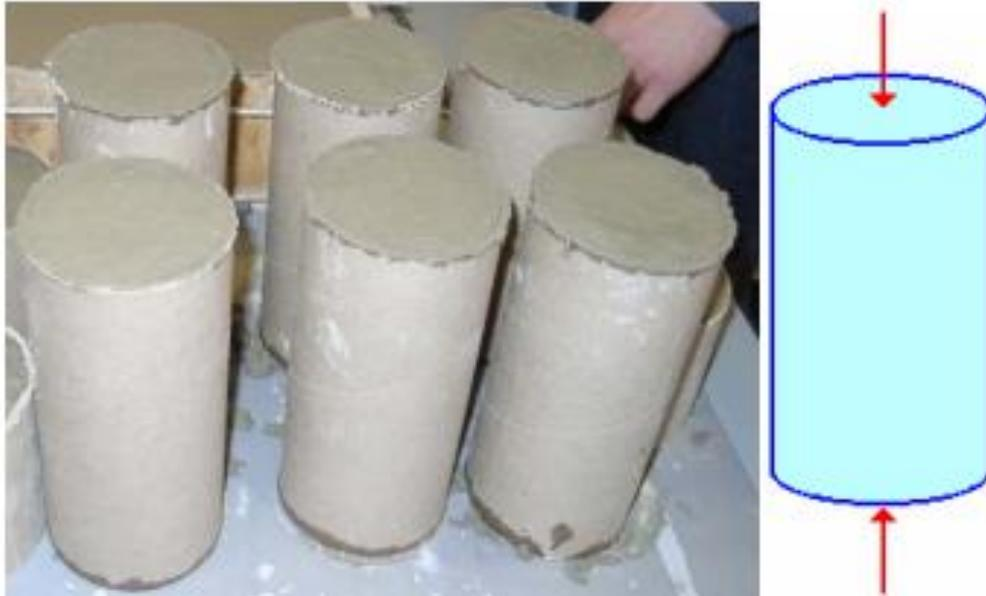
**Imagen 1.** Cilindros para ensayos a compresión
