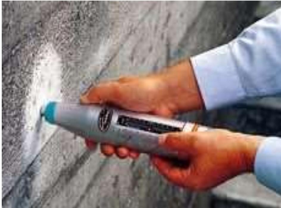
**Ilustración 11.** Ensayo del esclerómetro.
