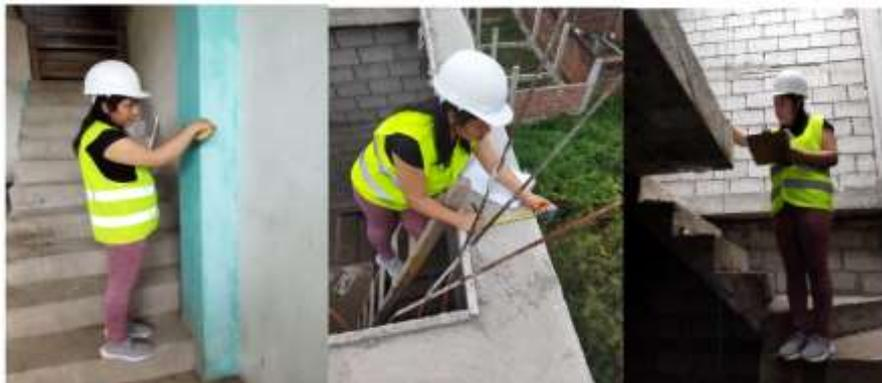
**Fotografía 4.** Toma de lecturas en columna, viga y losa.
