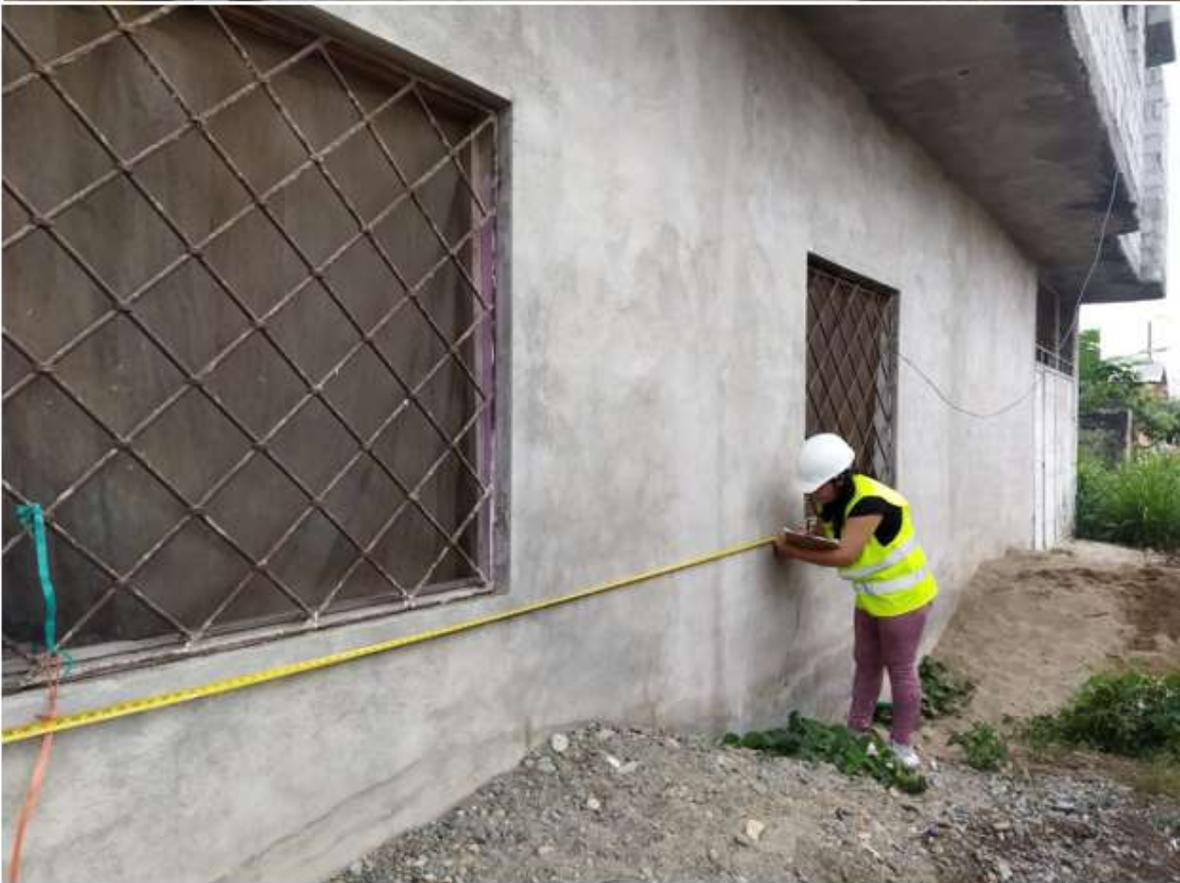
**Fotografía 8.** Levantamiento geométrico de las viviendas.
