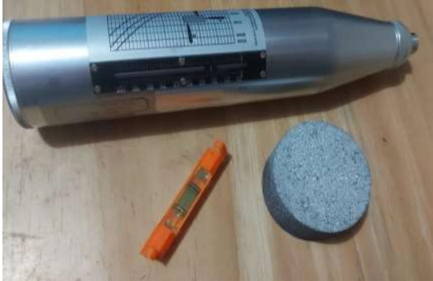
**Ilustración 12.** Equipos para el ensayo del esclerómetro.
