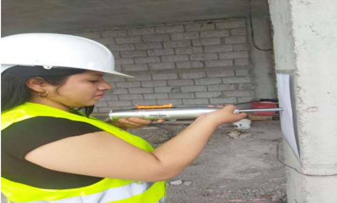
**Fotografía 11.** Colocación del esclerómetro a 0° con el nivel para el impacto.
