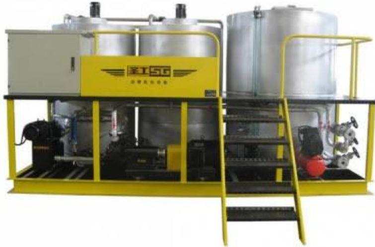
**Figura 5: Planta de Emulsión Asfáltica**
