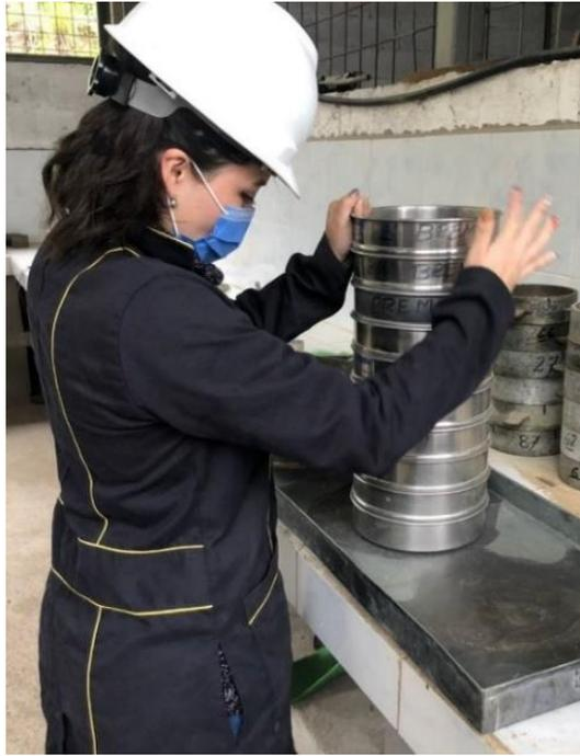
**Figura 26: Ensayo de granulometría.**
