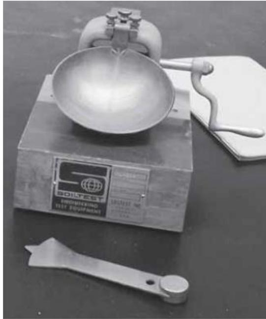
**Figura 15: Límite líquido. Método Casagrande**
