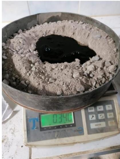
**Figura 27: Preparación de muestra con Emulsión Asfáltica para el Ensayo de Compactación**
