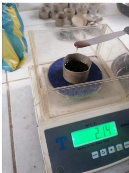
**Figura 29: Preparación de muestra con Terrasil para el Ensayo de Compactación**
