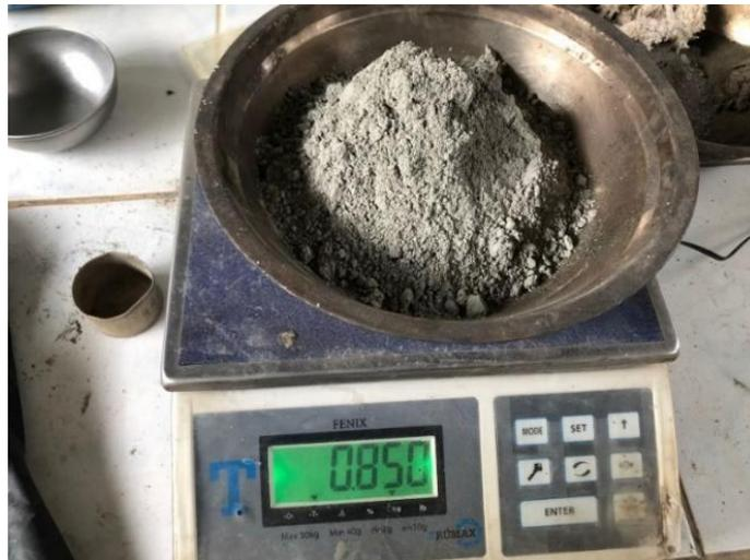
**Figura 28: Preparación de muestra con Cemento para el Ensayo de Compactación**
