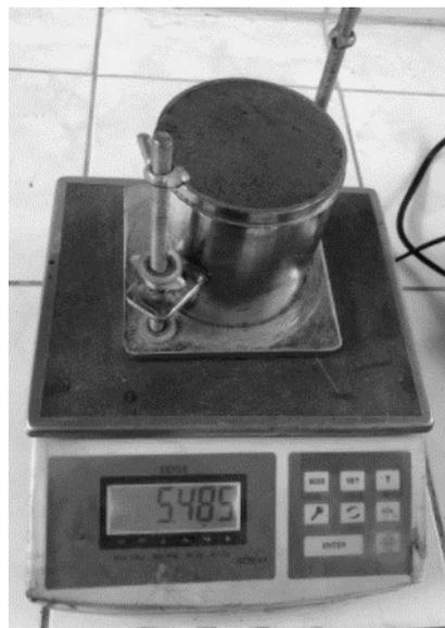
**Figura 31: Preparación de cilindros de ensayo CBR.**
