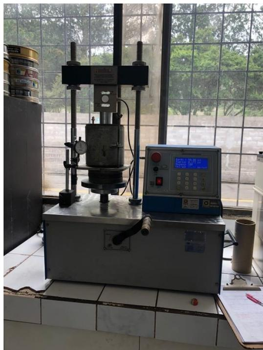
**Figura 33:** Ensayando los cilindros de CBR.
