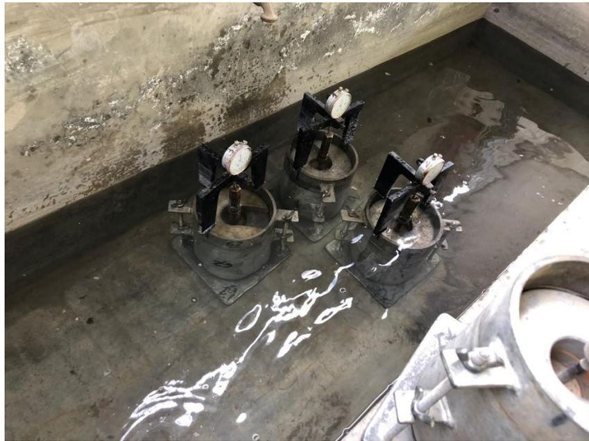
**Figura 32:** Sumergiendo en el agua los cilindros de ensayo CBR
