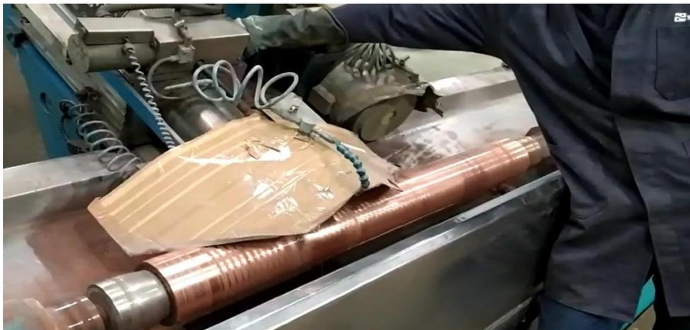
*Figura 6. Pulido de cilindros (Fotografía: Myriam Pallo G.)*
