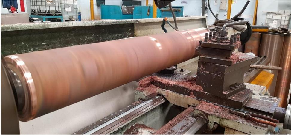
*Figura 5. Rectificado de cilindros (Fotografía: Myriam Pallo G.)*
