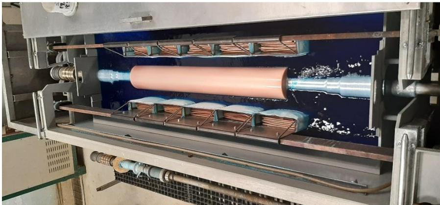
*Figura 4. Cobreado en celda Electrolítica (Fotografía: Myriam Pallo G.)*
