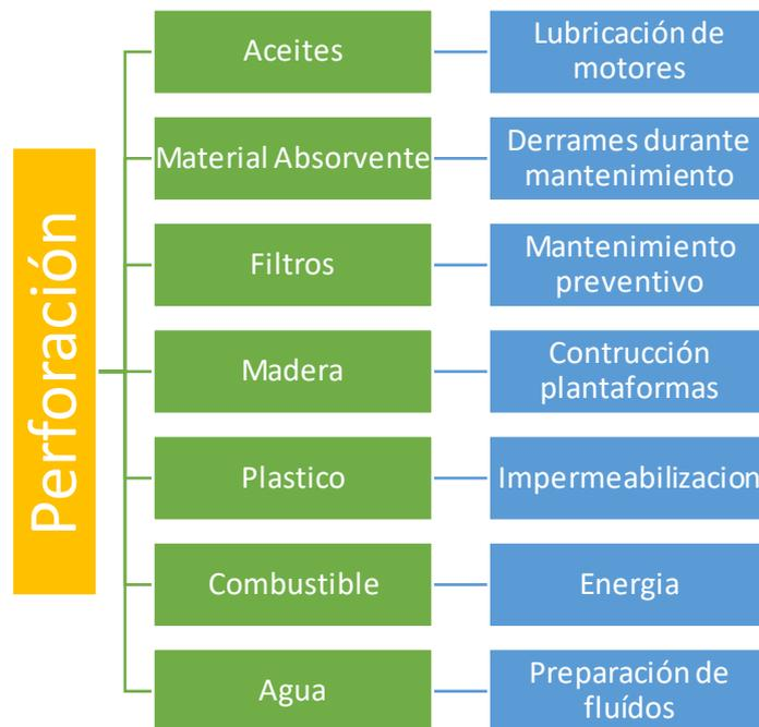
Figura 3 Detalle de los insumos utilizados en el proceso de perforación
