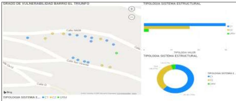
FIGURA 56: GRADO DE VULNERABILIDAD SISMICA DEL BARRIO EL TRIUNFO POR TIPOLOGIA SEGÚN LA NEC 2015.
