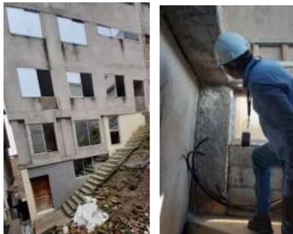
FIGURA 46: ENSAYO ESCLEROMETRO– BARRIO EL TRIUNFO
