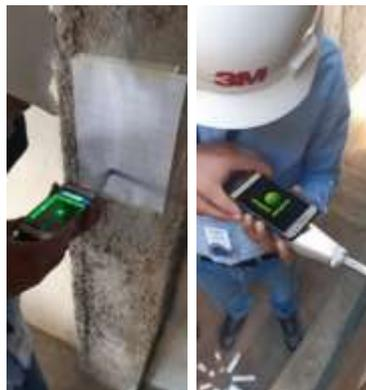
FIGURA 48: ENSAYO ESCLEROMETRO – NIVELACION PERPENDICULAR A LA SECCIÓN.
