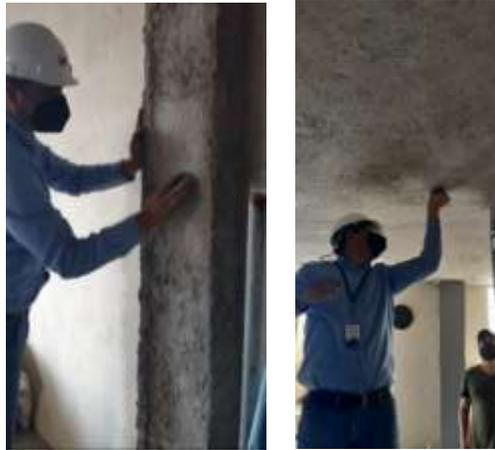
FIGURA 47: ENSAYO ESCLEROMETRO – PREPARACIÓN DE AREA A ENSAYAR.
