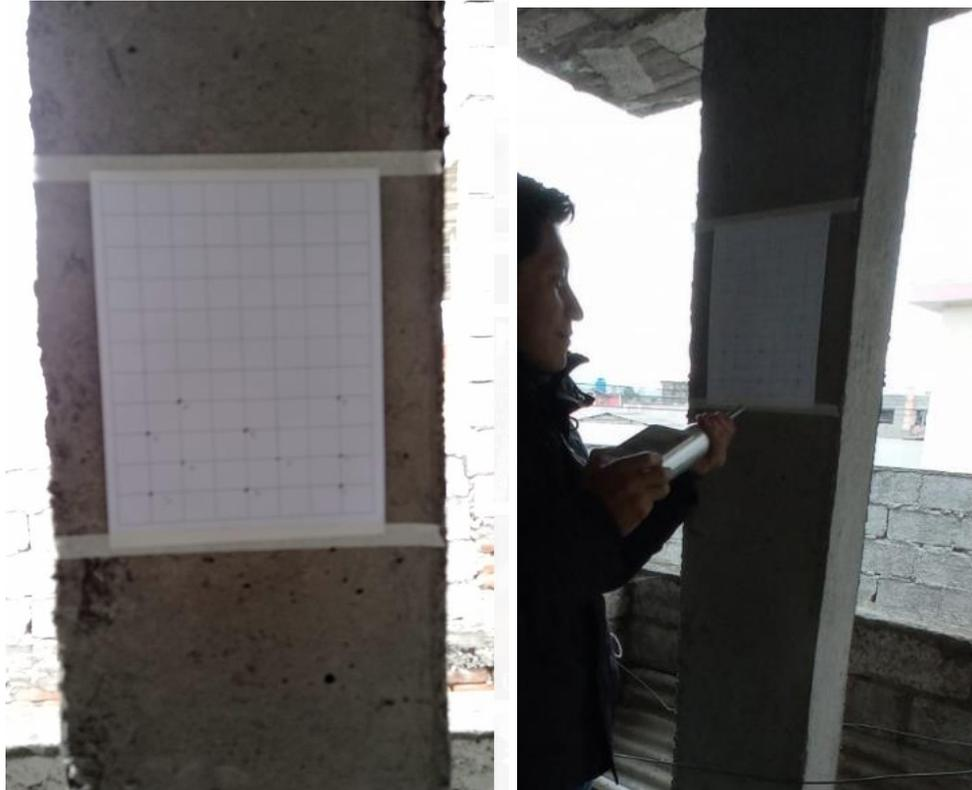
*Figura 47: Cuadrícula y uso del esclerómetro
