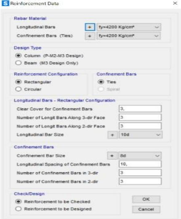
Figura 72: Propiedades del acero, estribos y recubrimiento
