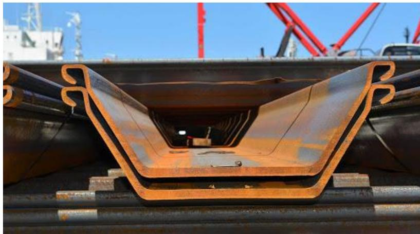
*Ilustración 5. Tablestacas de Acero.*
