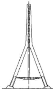
Ilustración 40. Torre con configuración de Y invertida.
