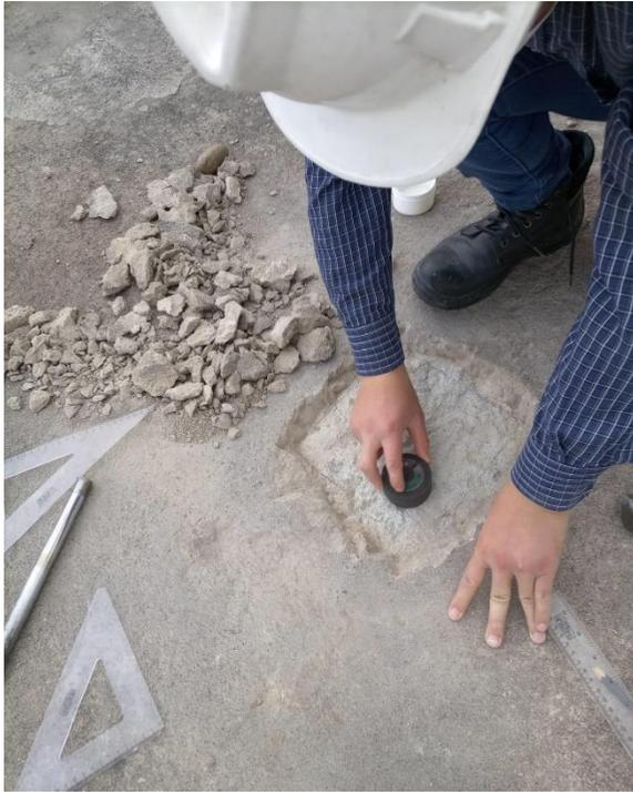
Preparación de superficie de prueba con piedra abrasiva, losa 2P.
