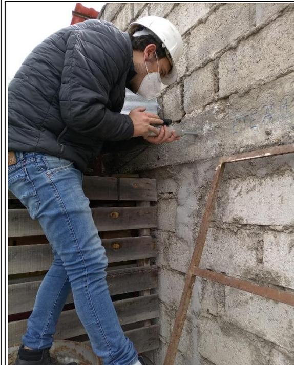
Índice de rebote Viga EJE A'1.
