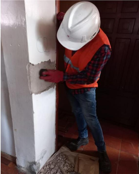
Preparación del área de superficie de prueba columna C2, con piedra abrasiva.
