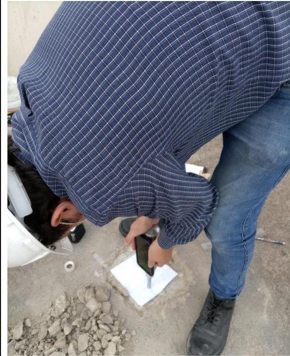
Índice de rebote losa, planta alta.
