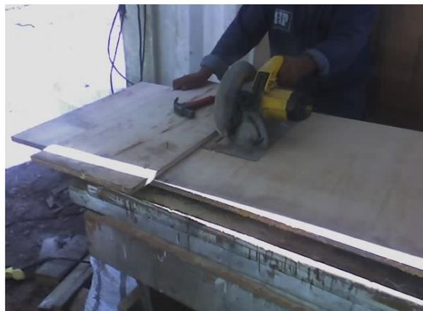
Corte simétrico de tablas triplex
