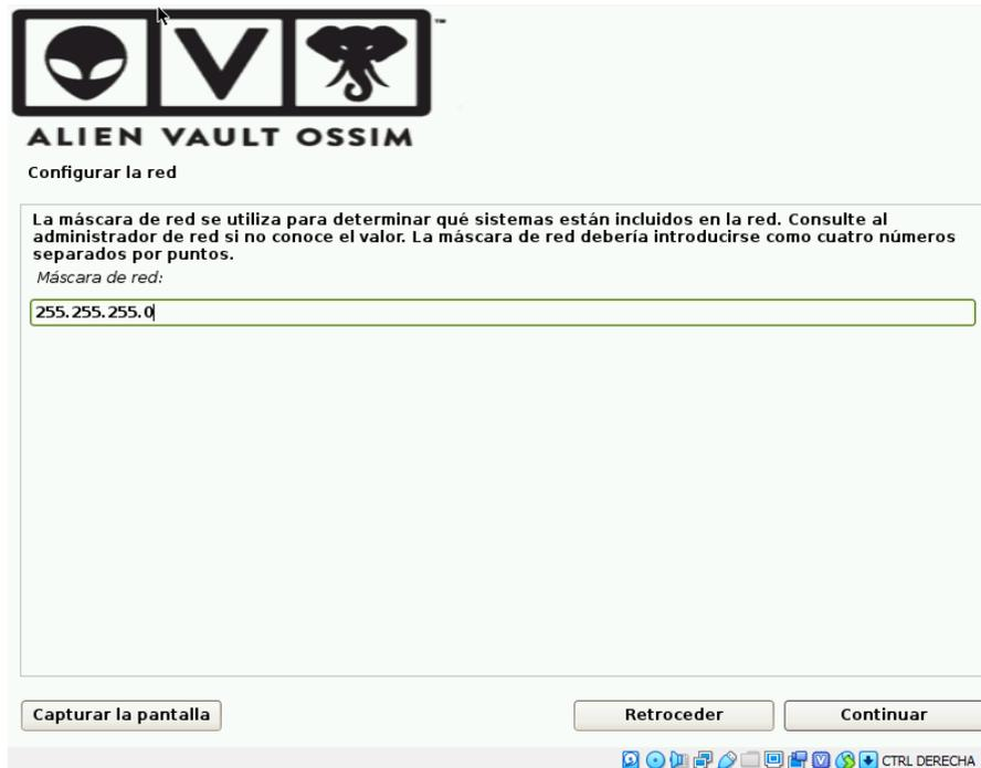
**Figura 25:** Configuración OSSIM AlienVault: Configuración máscara de red.
