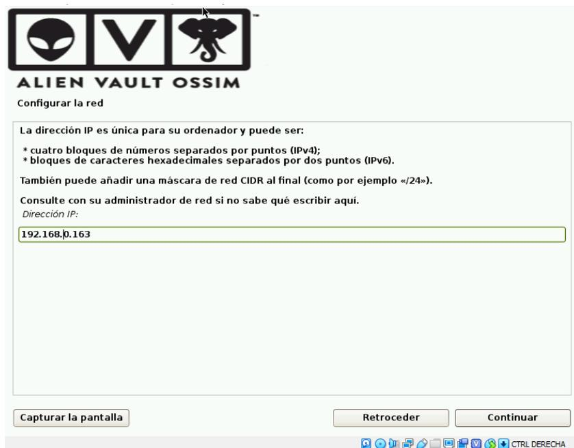
**Figura 24:** Configuración OSSIM AlienVault: Configuración IP (OSSIM AlienVault)
