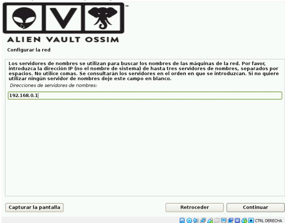
**Figura 27:** Configuración OSSIM AlienVault: Configuración DNS.
