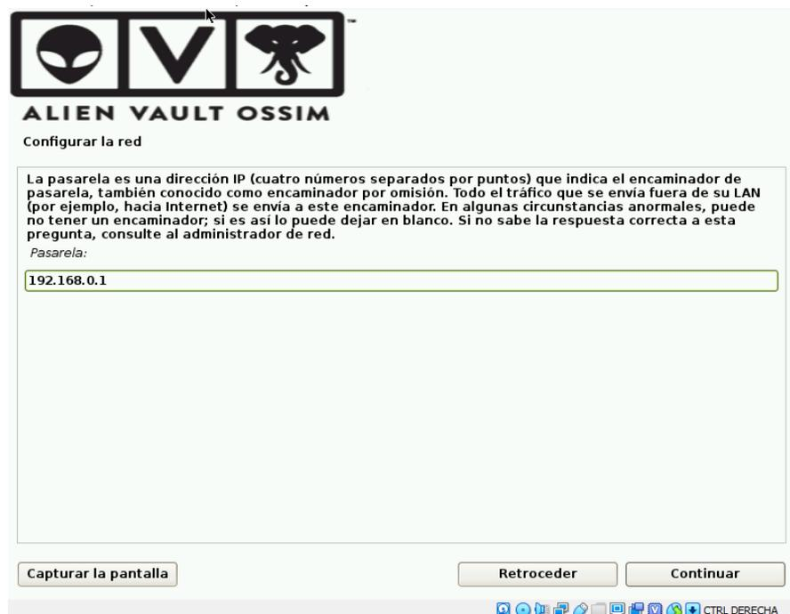
**Figura 26:** Configuración OSSIM AlienVault: Configuración *Gateway*.
