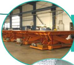
Implantación de mesas con elevador hidráulico y transporte de rodillos, para facilitar el transporte de láminas y paneles.
