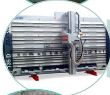
El área de corte de paneles, se ve comprometido por condiciones materiales, por lo que se recomienda la adquisición de maquinaria (sierra de corte vertical), maquinaria que contribuirá a disminuir el riesgo en esta actividad y mejorar el nivel de precisión.
