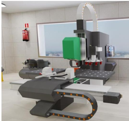
En la figura 23 Fresadora CNC accionada por código G, con lenguaje en coordenadas de movimientos y profundidad para realizar la pieza o elemento a procesar.
