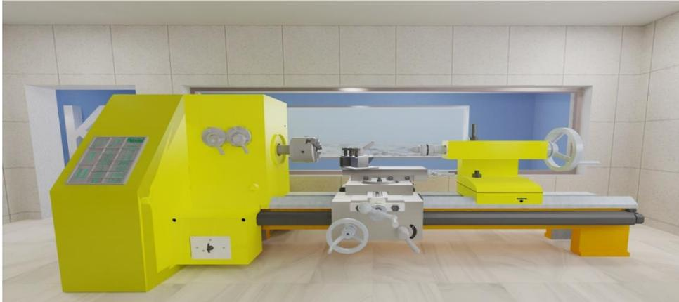
En la figura 22 Modelado de un torno, mediante el cual se realiza procesos de desbaste o arranque de viruta en piezas con medidas o formas que el maestro o estudiante lo requieran.
