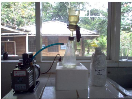
**Foto 7:** Filtración de la muestra de agua
