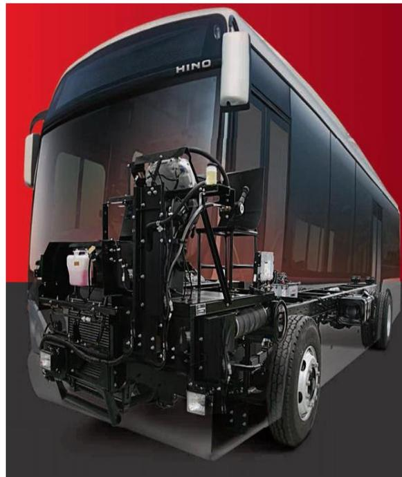
*Figura 6 Chasis de Hino AK8JRSA con posible carrocería de bus (Teojama Comercial, 2014)*
