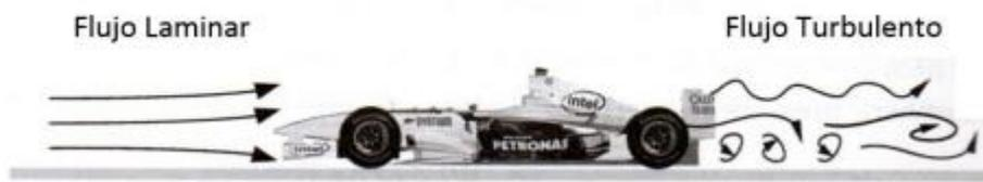
Figura 10 Flujo laminar y turbulento de un vehículo (SAMANIEGO FLOR, 2018)
