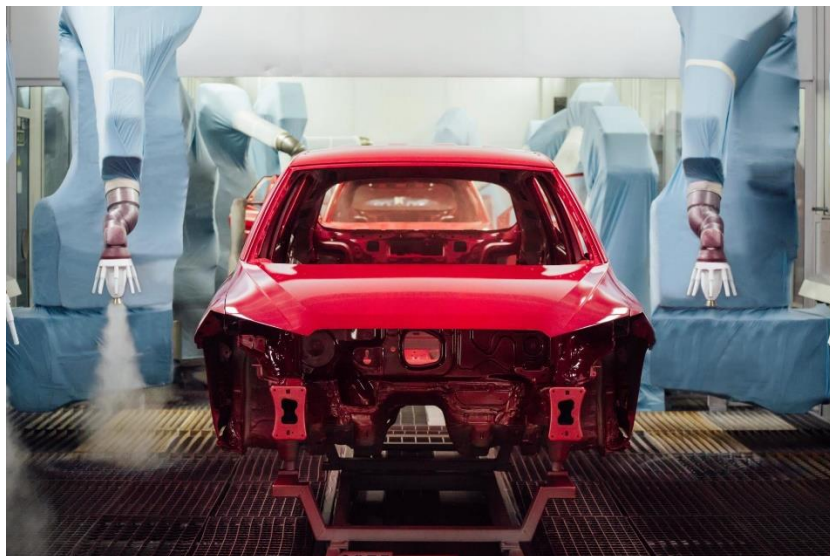
Figura 70. Pintado por medio de robots del chasis de un auto Fuente: (Seat, 2018)
