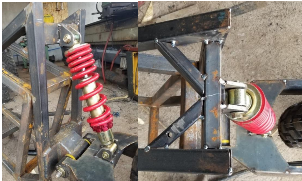
Figura 119. Soldadura del soporte del amortiguador y refuerzos.
