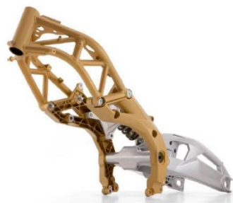
Figura 5. Chasis en sistema cantiléver. Fuente: (Larrauri, 2012)
