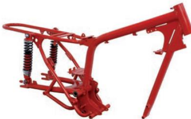
Figura 7. Chasis simple cuna abierto.
