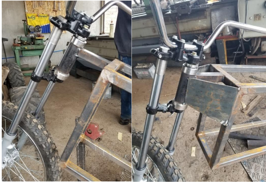
Figura 118. Soldadura del tubo de la dirección con el chasis y refuerzo con platina.
