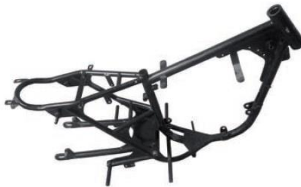
Figura 6. Chasis simple cuna cerrado. Fuente: (Casajús, 2012)
