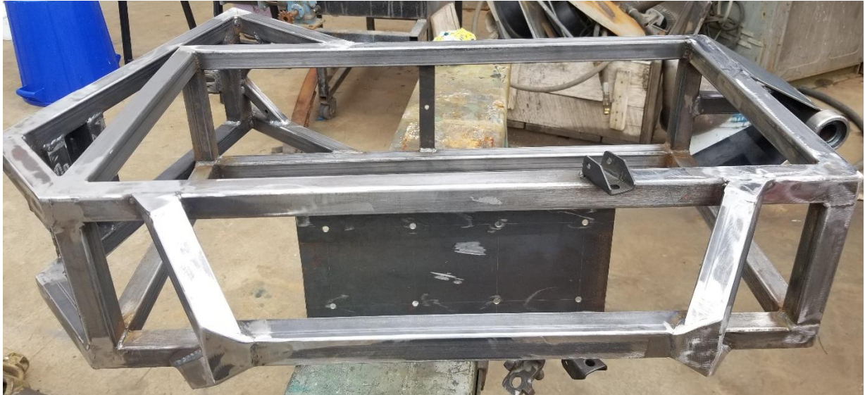
Figura 127. Vista inferior del chasis después de haber sido lijado completamente.
