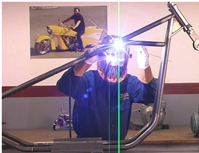
Figura 67. Soldadura TIG de los tubos en el Chasis Fuente: (Tyler, 2019).
