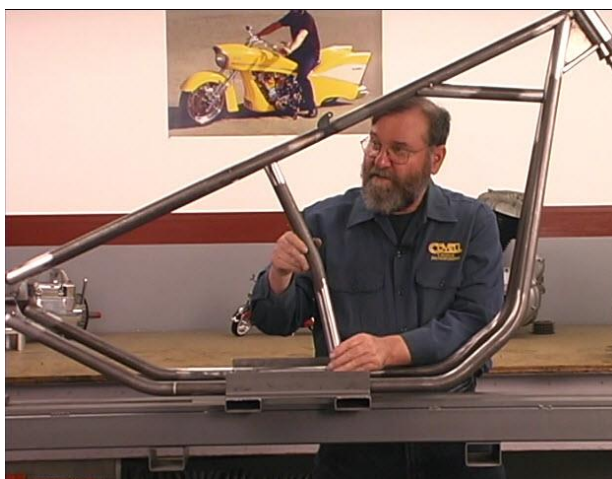
Figura 64. Alineación y ensamblaje de tubo en el marco Fuente: (Tyler, 2019)
