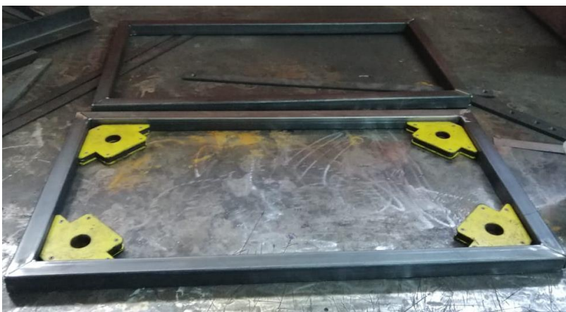
Figura 109. Construcción del primer cuadrado del chasis con sus ángulos rectos.
