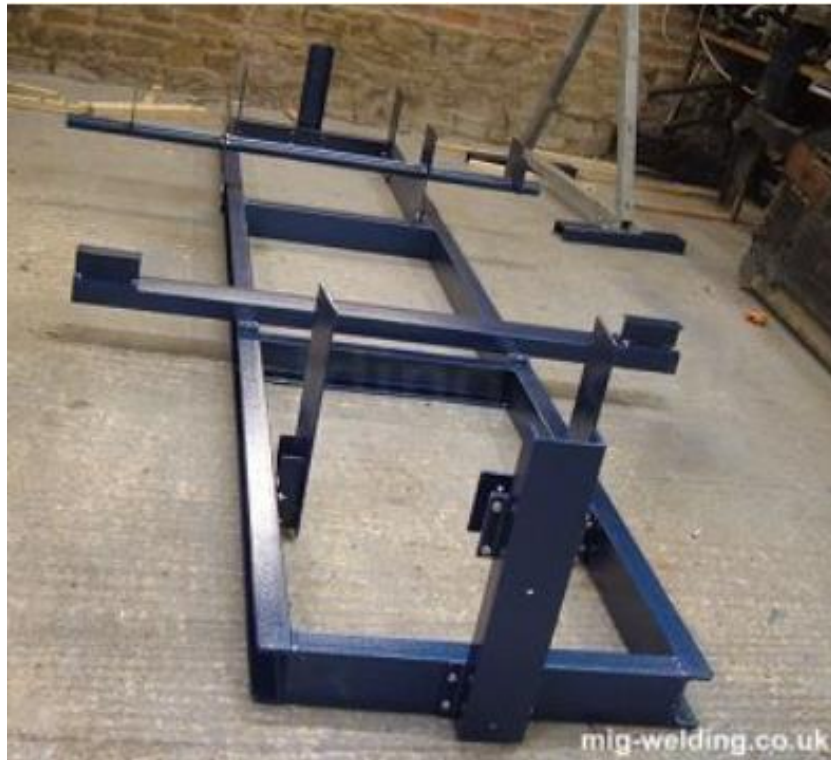
Figura 61. Ejemplo de un Jig para corte de los tubos del chasis Fuente: (Migwelding, 2016)
