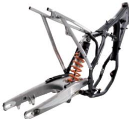
Figura 8. Chasis simple cuna desdoblado, KTM 250X.
