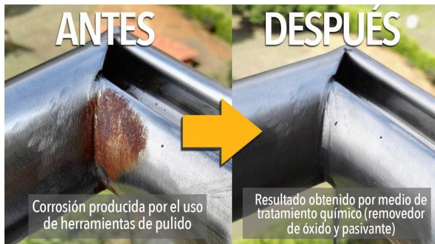
Figura 65. Limpieza química de las juntas a soldar y de las juntas soldadas Fuente: (Erco, 2019)
