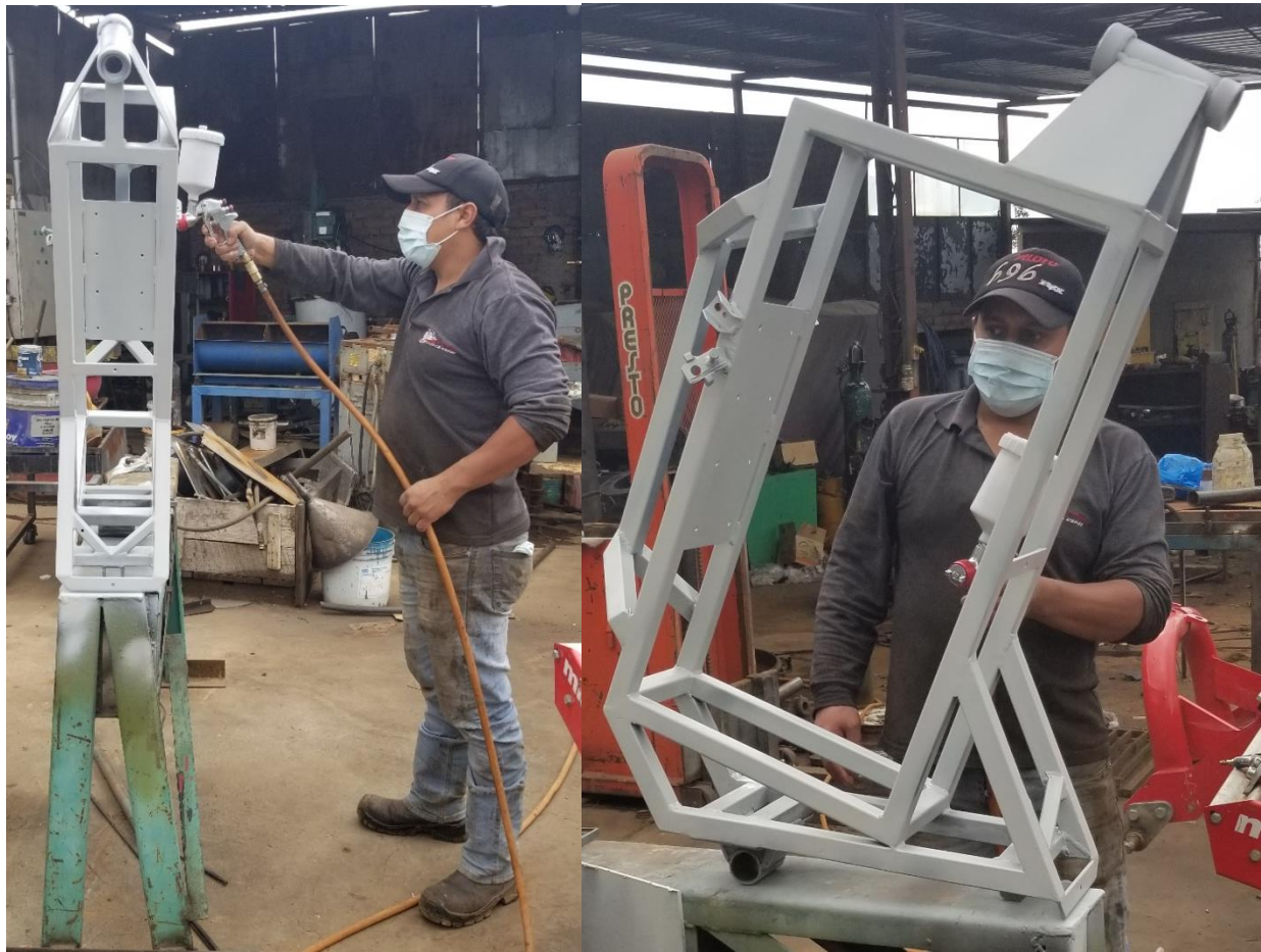
Figura 129. Proceso de pintura con soplete.
