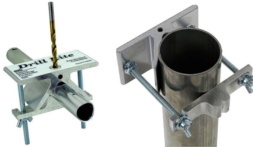
Figura 62. Jig para taladrar los tubos y hacer ranuras Fuente: (Our warehouse, 2015)
