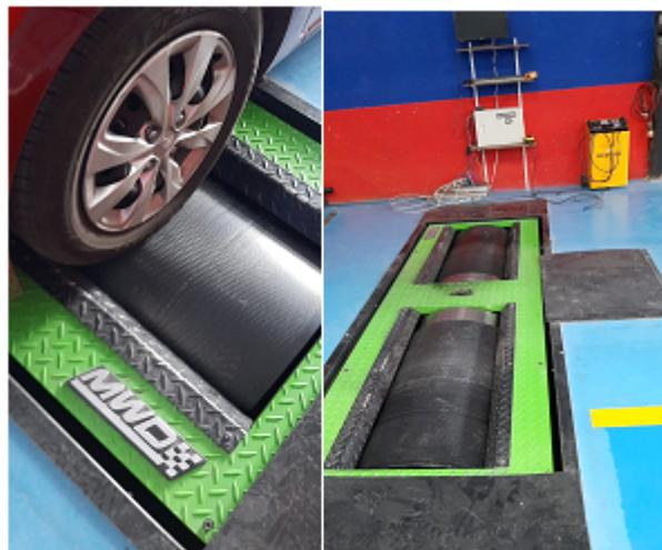
*Figura 20.* Rodillo inercial MWD RR760i. Instalación y posicionamiento del vehículo.
