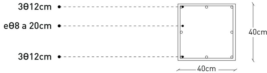
**DETALLE SECCIÓN 1 ARMADO VIGA**
