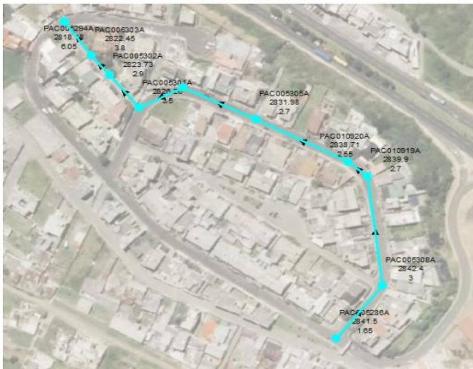
*Figura 7 Datos topográficos de la red de alcantarillado*
