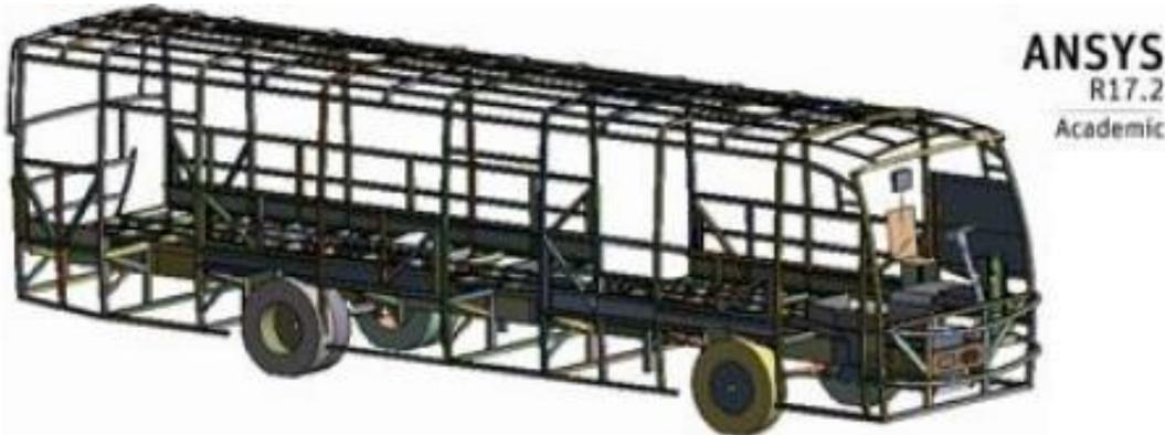
Figura 3. Modelo de la superestructura del autobús. Tomado de (Avilés, R; 2017.p28)
