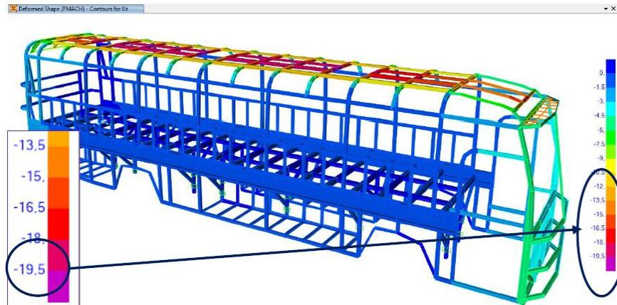
Figura 9. Deformación de la cercha superior II según el método LRFD. Tomado de (Esmeraldas, 2016)
