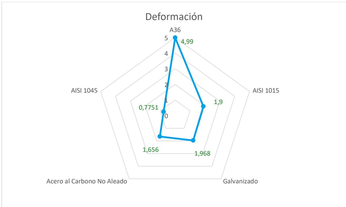
Figura 78. Resultados de Análisis de las Deformaciones de los materiales.
