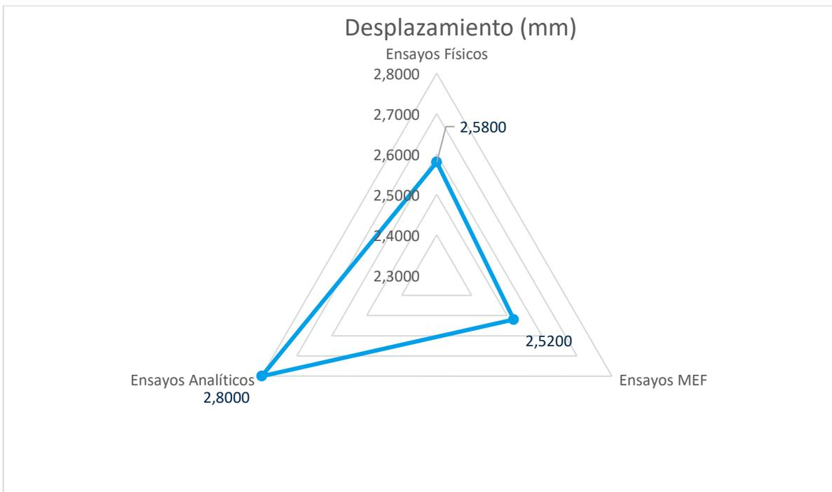
Figura 71. Resultados comparativos de los ensayos de flexión de los análisis de desplazamientos
